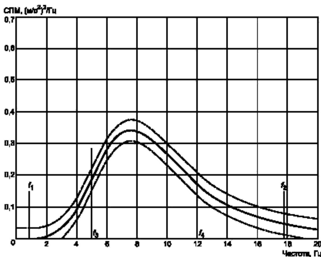
Рисунок 7 — СПМ для спектрального класса ЕМ 6 (гусеничные самосвалы, гусеничные бульдозеры, гусеничные погрузчики массой менее 50000 кг)
