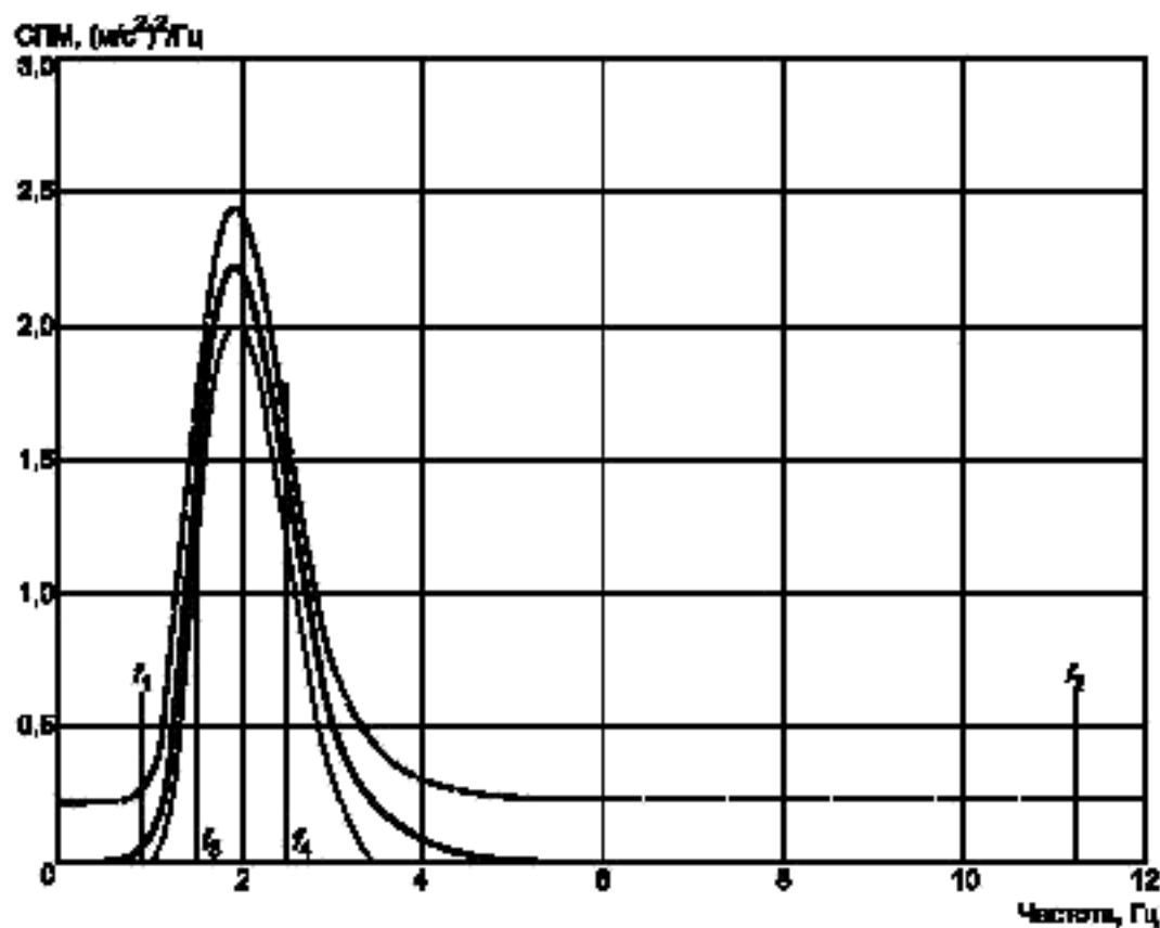
Рисунок 2 — СПМ для спектрального класса ЕМ 1 (самосвал с жесткой или шарнирно-сочлененной рамой снаряженной массой более 4500 кг)
