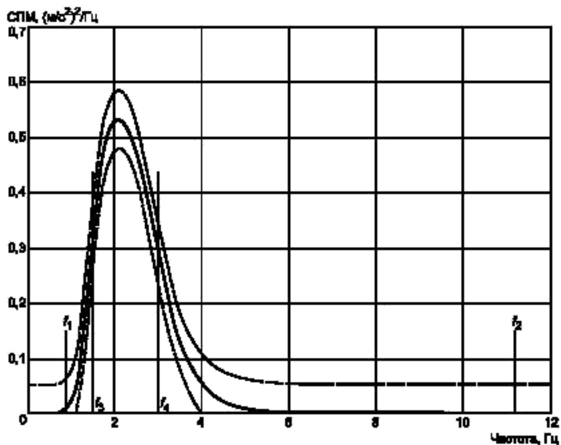
Рисунок 5 — СПМ для спектрального класса ЕМ 4 (грейдеры)
