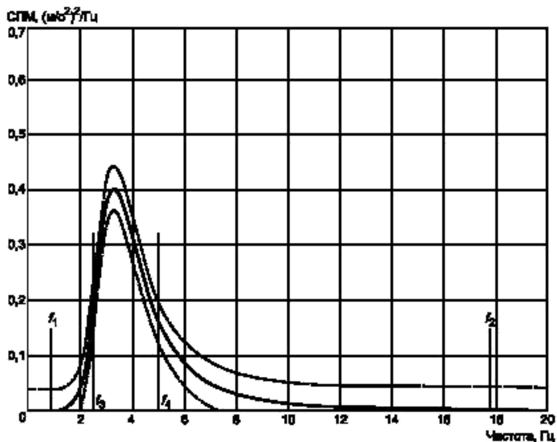
Рисунок 9 — СПМ для спектрального класса ЕМ 8 (мини-погрузчики массой менее 4500 кг)
