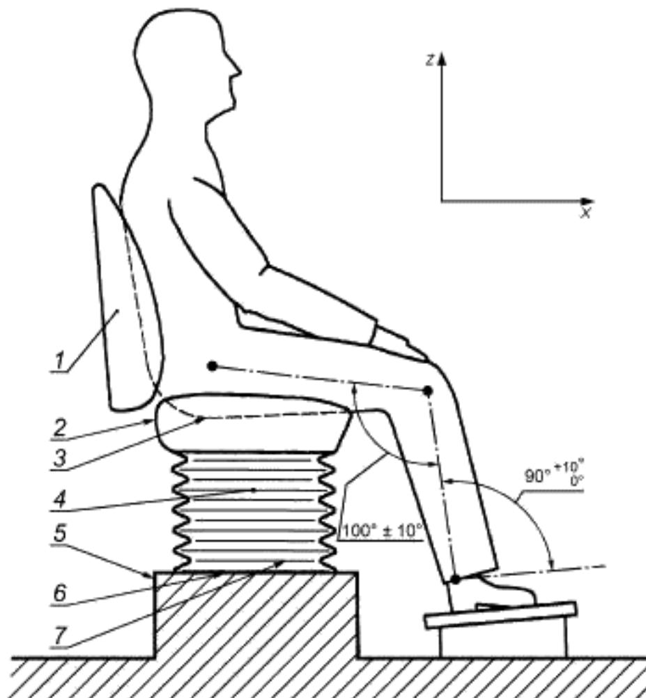
1 — спинка сиденья; 2 — подушка сиденья; 3 — диск с закрепленным акселерометром на подушке сиденья ( $S$ ); 4 — подвеска сиденья; 5 — платформа; 6 — акселерометр, установленный на поверхности платформы ( $P$ ); 7 — опора сиденья
