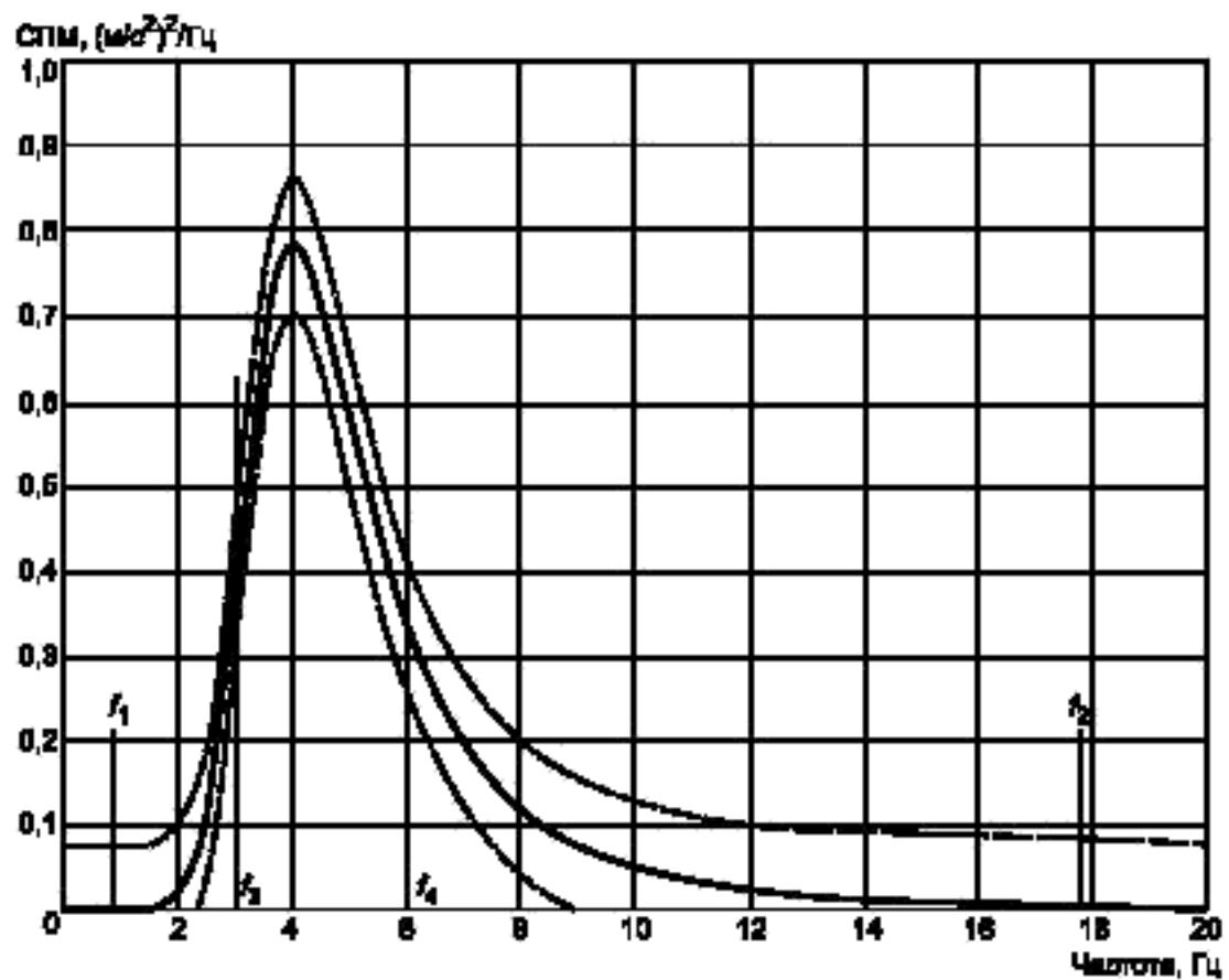
Рисунок 10 — СПМ для спектрального класса ЕМ 9 (погрузчики с бортовым поворотом массой менее 4500 кг)
