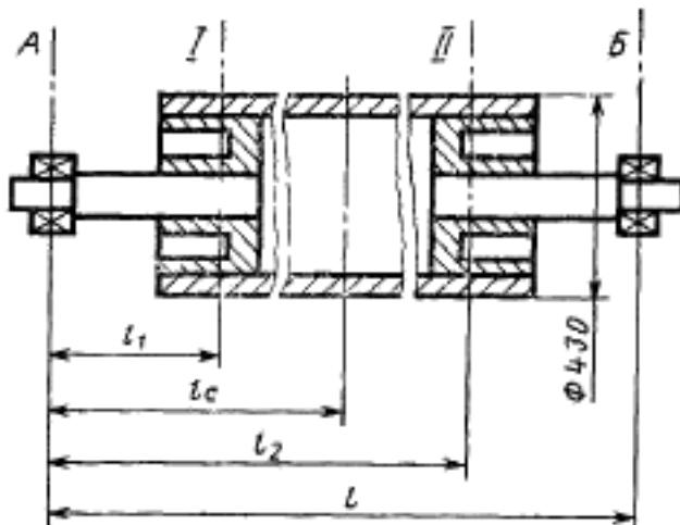
3. При симметричном расположении плоскостей коррекции относительно центра масс роторов допустимые остаточные дисбалансы в обеих плоскостях коррекции равны
