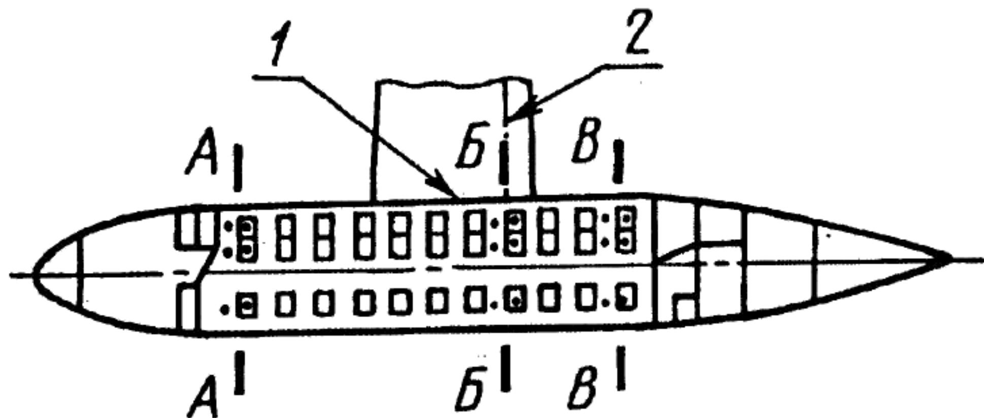
*A, B, V — сечения; 1 — корневая нервюра; 2 — задний лонжерон*
