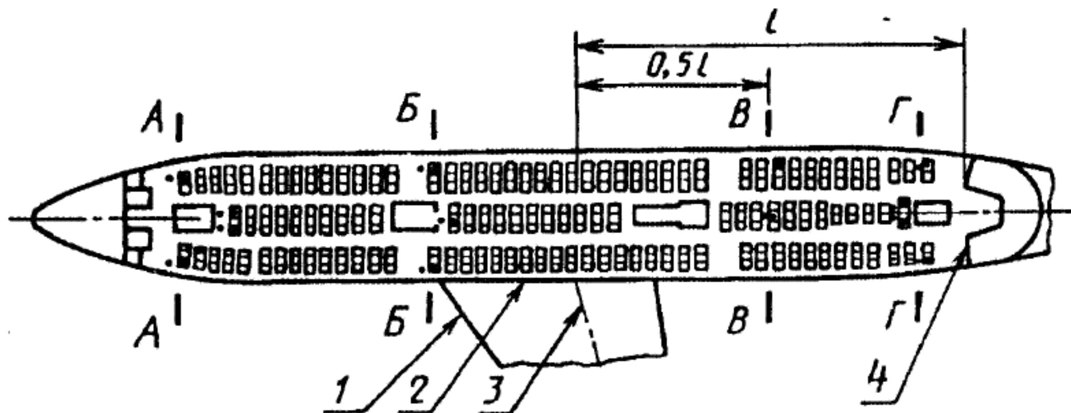
*A, Б, В, Г — сечения; 1 — передняя кромка крыла; 2 — корневая нервюра; 3 — задний лонжерон; 4 — задняя стенка пассажирской кабины*
