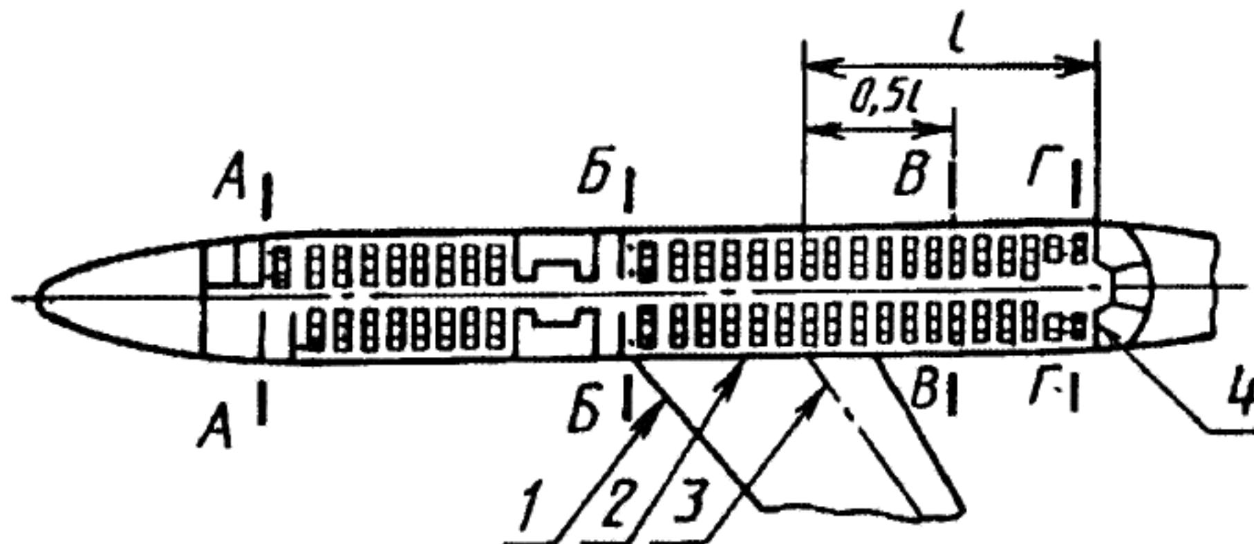
*A, Б, В, Г — сечения; 1 — передняя кромка крыла; 2 — корневая нервюра; 3 — задний лонжерон; 4 — задняя стенка пассажирской кабины*
