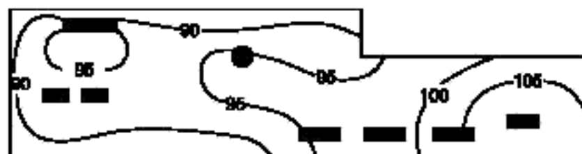
в) Линии равных уровней шума (здесь с шагом 5 дБ)
