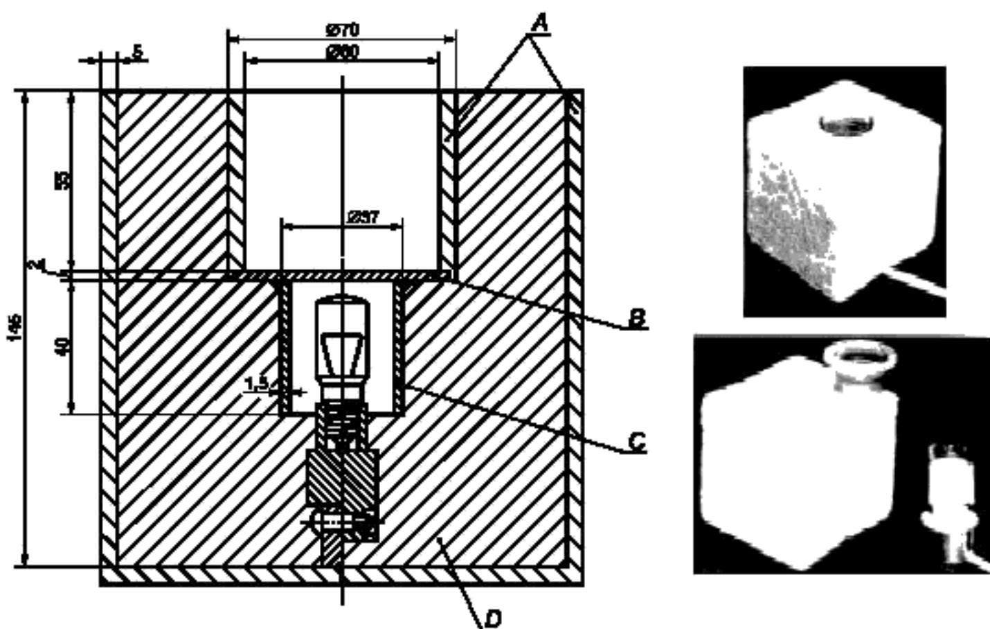
А — изолирующий материал; В — медная пластина; С — медная трубка;
