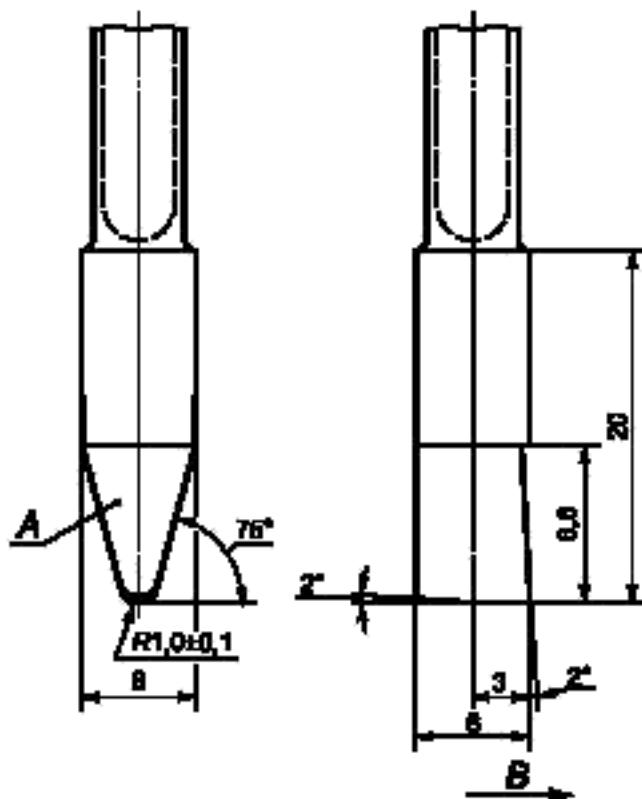
A — твердосплавный наконечник типа К10 по ГОСТ 3882; В — направление движения
