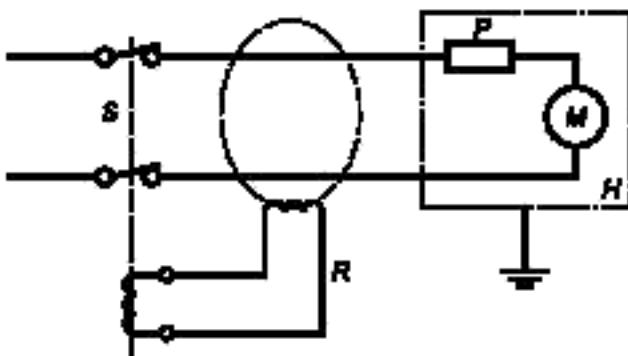
S — источник питания; H — корпус; R — устройство остаточного тока ( $I_{\text{ст}} = 30 \text{ мА}$ ); P — устройство тепловой защиты двигателя (наружное или внутреннее), если имеется; M — двигатель
