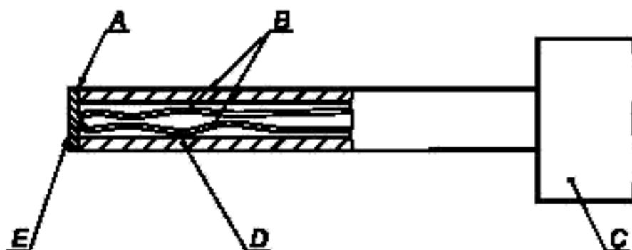
A — связывающее вещество; B — термопара из проволоки диаметром 0,3 мм типа К (хромоникелевый сплав) по ГОСТ Р 8.585; C — ручное устройство, разрешающее контакт с силой  $(4 \pm 1)$  Н; D — поликарбонатная труба внутренним диаметром 3 мм, наружным диаметром 5 мм; E — покрытый оловом медный диск диаметром 5 мм, толщиной 0,5 мм
