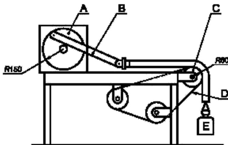
А — кривошипный механизм; В — соединительный стержень, С — ролик диаметром 120 мм,
