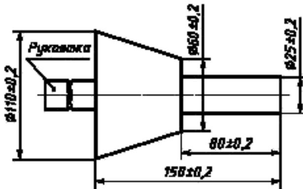
Рисунок 101 — Испытательный калибр
