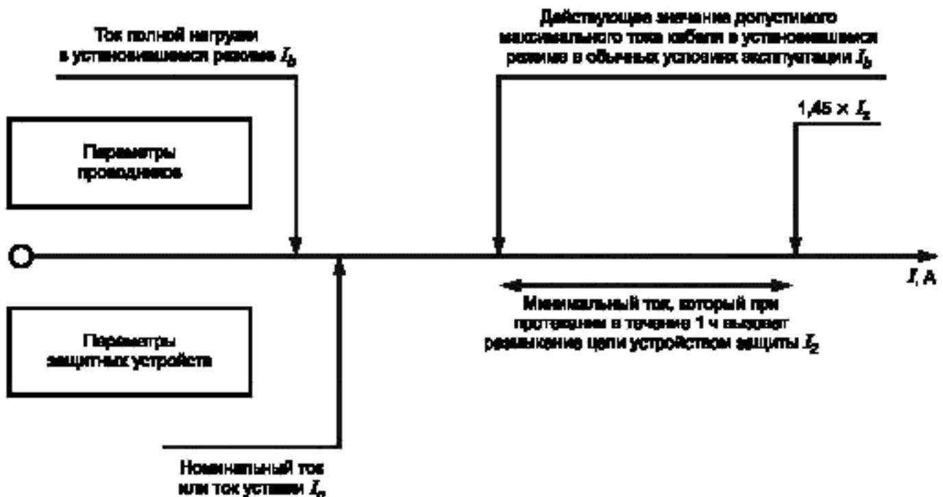
Рисунок D.2 — Параметры проводников и защитных устройств
