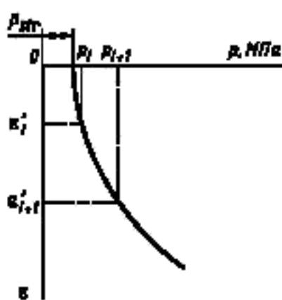
**График 2 — Относительное сжатие глинистого грунта при частичном разуплотнении в зависимости от давления  $p$**
