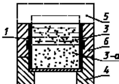
1 — рабочее кольцо срезного прибора; 2 — материал; 3 — грунт (лед, грунтовый раствор); 3-а — грунт;
