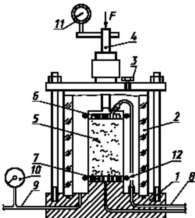
1 — основание камеры; 2 — корпус камеры; 3 — вентиль для выпуска воздуха; 4 — шток, 5 — образец грунта в оболочке; 6 — верхний штамп; 7 — нижний штамп; 8 — трубы для дренирования и измерения давления в поровой жидкости; 9 — трубка для заполнения камеры и измерения давления в камере; 10 — манометр; 11 — индикатор; 12 — уплотнитель
