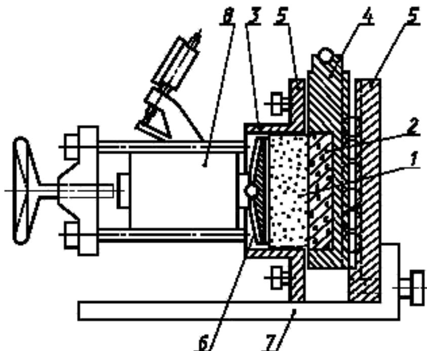
1 — мерзлый грунт; 2 — материал; 3 — рабочее кольцо; 4 — срезная каретка; 5 — корпус прибора; 6 — боковой штамп; 7 — опорная пластина; 8 — динамометр
