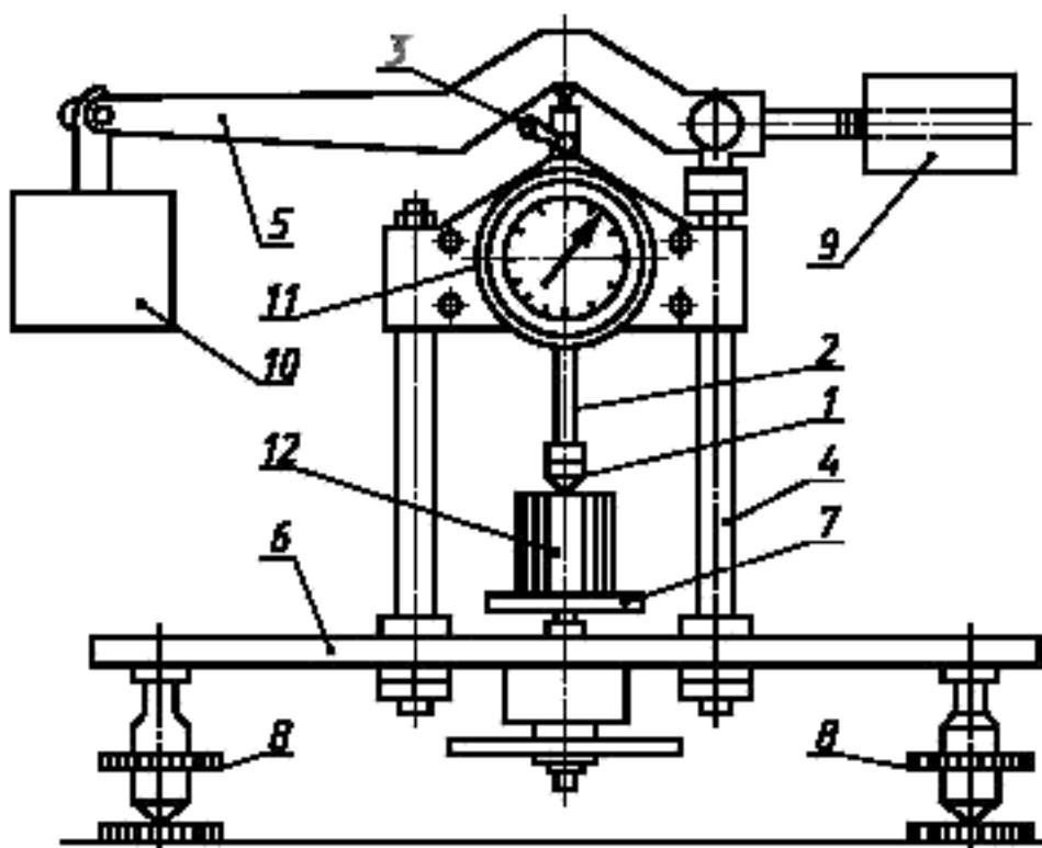
1 — шариковый штамп; 2 — подвижной стержень с держателем шарика; 3 — ручка стопорного винта; 4 — стойки;
