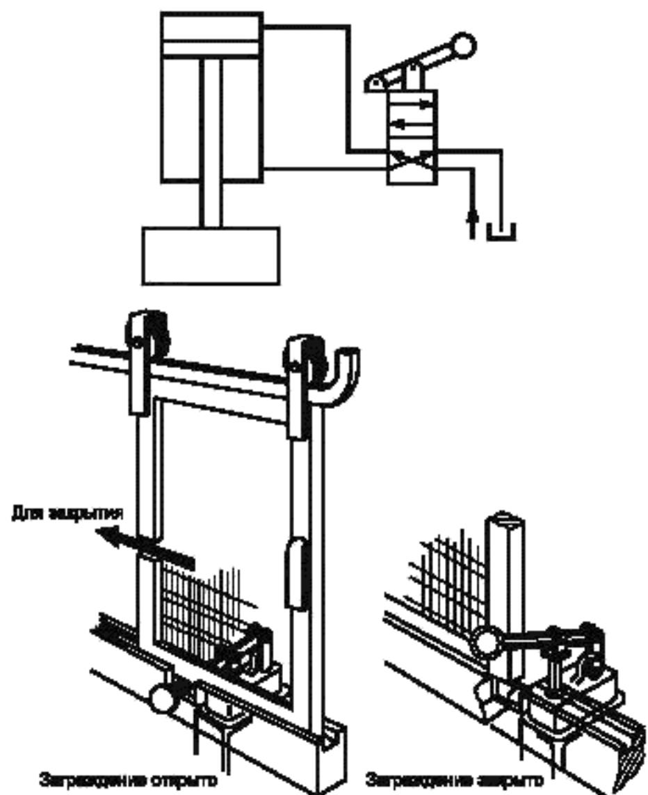
Рисунок D.2 — Пример блокировки питания (см. 5.4.1.6)
