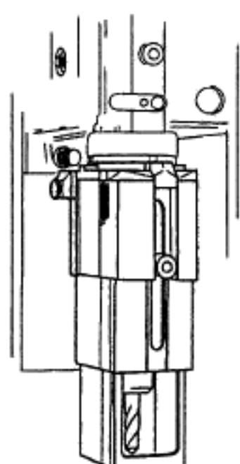
Рисунок 5 — Регулируемое съемное защитное устройство
