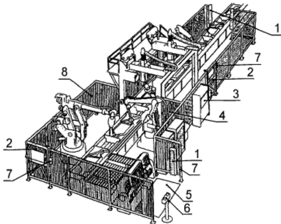
1 — фотозелектрический барьер; 2 — съемное защитное устройство с блокировкой; 3 — коммутационный шкаф; 4 — внутреннее ограждение, разрешающее допуск в определенном месте; 5 — изолирующий коврик; 6 — устройство для двуручного включения; 7 — орган возврата в исходное положение; 8 — съемное защитное устройство
