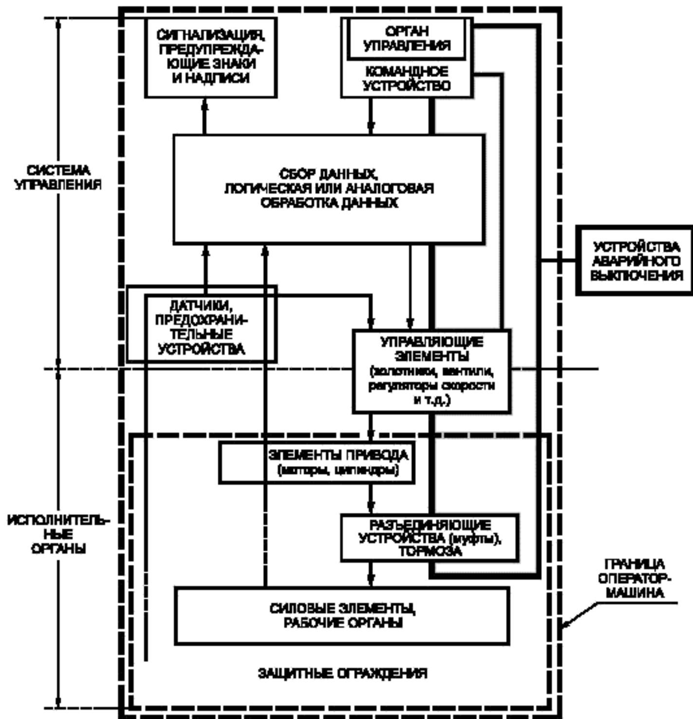
Рисунок 2 — Устройства аварийного отключения машины/сооружения
