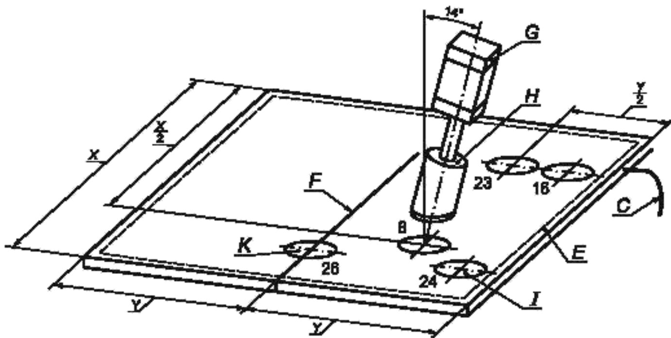
С — соединительный кабель (пример); Е — зона нечувствительности; F — линия сочленения, Г — внутренний диаметр пневматического цилиндра 50 мм, ход поршня 125 мм в соответствии с ИСО 6431; Н — контрольный образец б в соответствии с рисунком 2; І — случайно выбранная позиция; К — случайно выбранная позиция на линии сочленения; Х — длина датчика; У — ширина датчика
