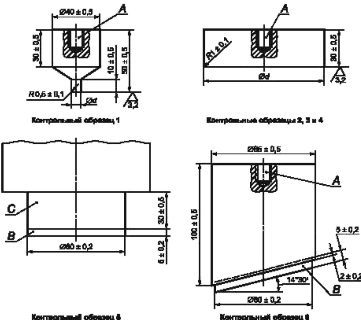
А — только для монтажа; В — наклеенный резиновый «башмак». твердость по Шору  $(60 \pm 5)$  А.
