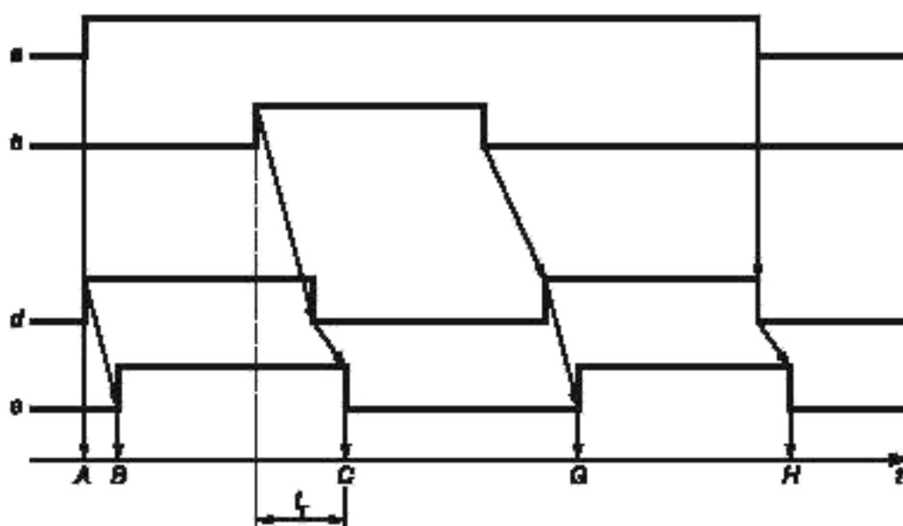
а — питание, поданное на коврик или пол; б — действующая сила; д — выход датчика, е — выходное состояние выходного переключателя (переключателей);  $t$  — время;  $t_r$  — время реагирования
