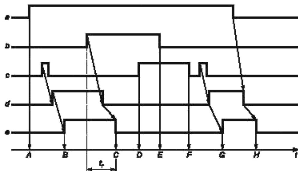
*a* — питание, поданное на коврик или пол; *b* — воздействующая сила; *c* — сигнал восстановления, *d* — выход датчика; *e* — выходное состояние выходного переключателя (переключателей), *t* — время; *t<sub>r</sub>* — время реагирования.
