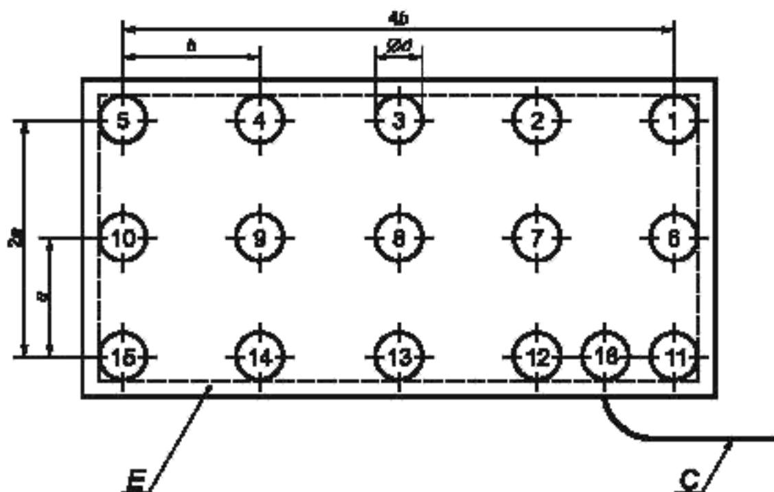
*C* — соединительный кабель (пример); *d* — диаметр соответствующего контрольного образца;
