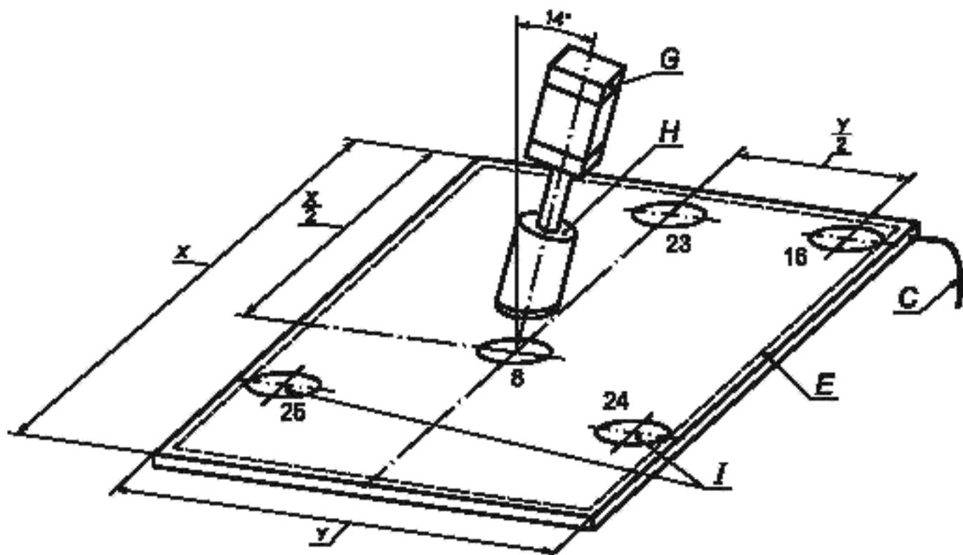
С — соединительный кабель (пример); Е — зона нечувствительности; Г — внутренний диаметр пневматического цилиндра 50 мм, ход поршня 125 мм в соответствии с ИСО 6431; Н — контрольный образец б в соответствии с рисунком 2; І — случайно выбранная позиция; Х — длина датчика; У — ширина датчика
