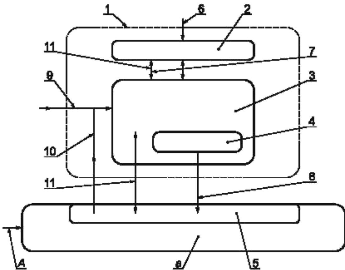
1 — обработка выходного сигнала коврика или пола, реагирующего на давление; 6 — воздействующая сила; 7 — выход датчика, 8 — сигнал замкнутого/разомкнутого состояния; 9 — сигнал ручного восстановления (при необходимости вместо А); 10 — сигнал восстановления от системы управления машиной (при необходимости); 11 — контрольные сигналы (необязательные). А — сигнал ручного восстановления для системы управления машиной (при необходимости вместо 9); а — система (системы) управления машиной
