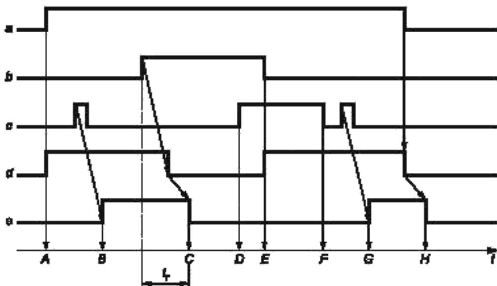
а — питание, поданное на коврик или пол; б — действующая сила; в — сигнал восстановления; д — выход датчика; е — выходное состояние выходного переключателя (переключателей);  $t_f$  — время;  $t_r$  — время реагирования
