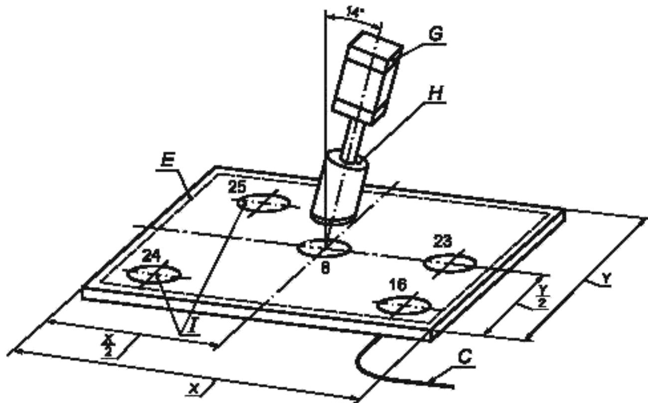
С — соединительный кабель (пример); Е — зона нечувствительности; Г — внутренний диаметр пневматического цилиндра 50 мм, ход поршня 125 мм в соответствии с ИСО 6431; Н — контрольный образец 6 в соответствии с рисунком 2, I — случайно выбранная позиция; Х — длина датчика; У — ширина датчика.
