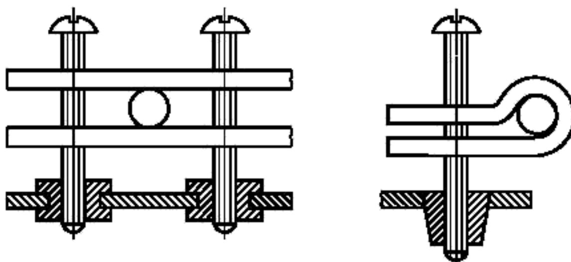
Винты, проходящие через резьбовые отверстия в машине (винты, проходящие через отверстия без резьбы в машине и закрепленные гайками), в одинаковой степени неприемлемы.
