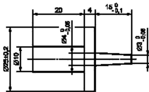
Рисунок 2 — Испытательный щуп
