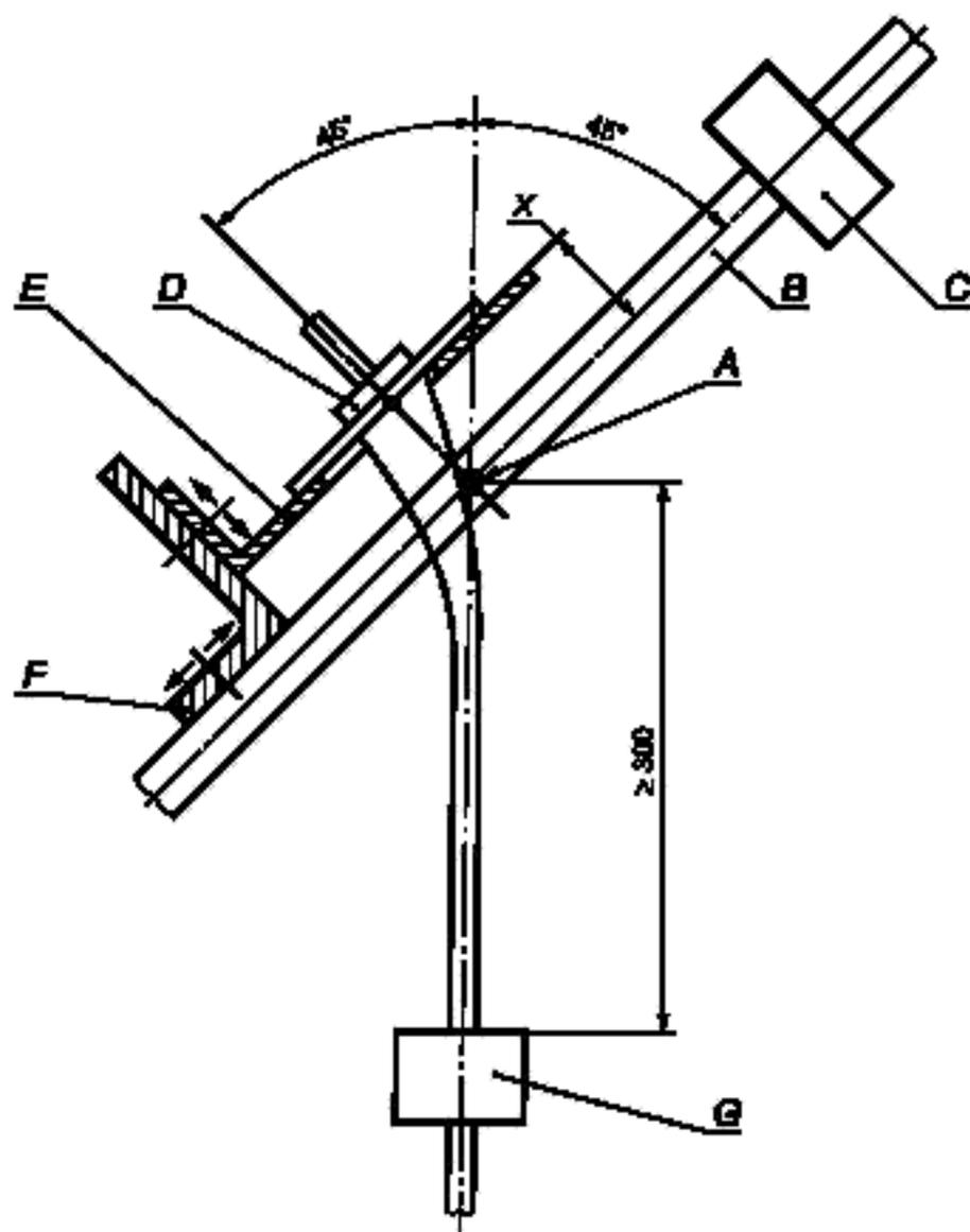
A — ось качания; B — качающая рама; C — противовес; D — образец;
