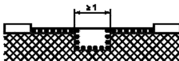
Условие — Рассматриваемый путь включает в себя паз шириной 1 мм или более с параллельными стенками любой глубины.
