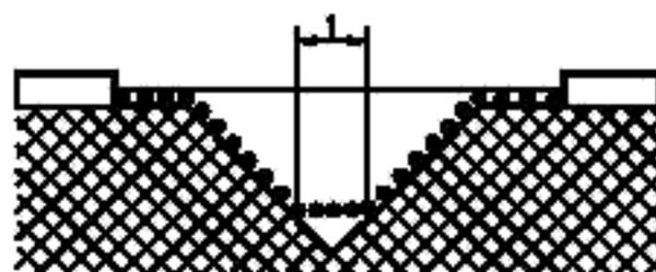
Условие — Рассматриваемый путь включает в себя V-образный паз шириной более 1 мм с внутренним углом менее  $80^\circ$ .
