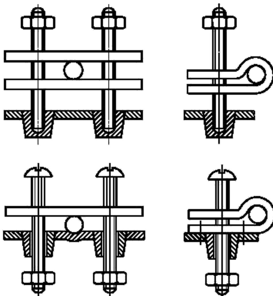
Часть машины выполнена из изоляционного материала и имеет форму, являющуюся частью зажимного устройства шнура.
