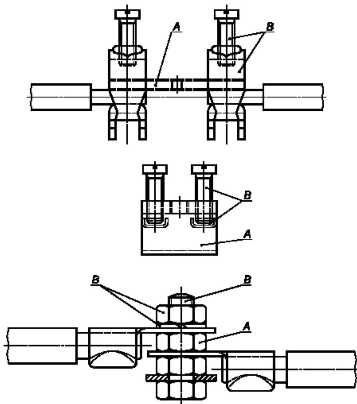
*A* — токопроводящая часть, обеспечивающая непрерывность заземления;
