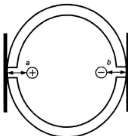
Размер  $a$  — расстояние от положительного оголенного проводника детали до наружной поверхности натянутой фольги, установленной через расщелины (или отверстия и т. п.); размер  $b$  — расстояние от отрицательного оголенного проводника детали (или части) до наружной поверхности натянутой (обтянутой) фольги, установленной через расщелины (или отверстия, щели и т. п.);  $a + b$  — общая сумма значений, установленных в К.28.1
