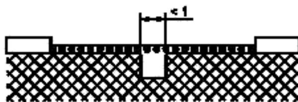
Условие — Рассматриваемый путь включает в себя паз шириной 1 мм с параллельными или сходящимися стенками любой глубины.
