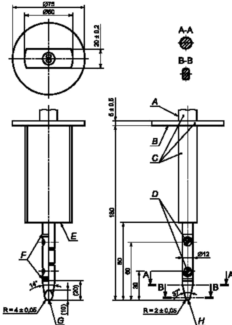
A — ручка; B — ограждение; C — изоляционный материал;
