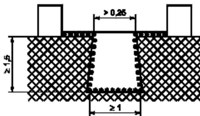
Условие — Рассматриваемый путь включает в себя паз с расходящимися боковыми стенками глубиной 1,5 мм или более, шириной в самом узком месте более 0,25 мм и шириной у дна паза 1 мм и более.
