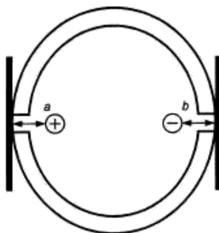
Размер  $a$  — расстояние от положительного оголенного проводника детали до наружной поверхности натянутой фольги, установленной через расщелину (или отверстие); размер  $b$  — расстояние от отрицательного оголенного проводника детали (или части) до наружной поверхности натянутой (или обтянутой) фольги, установленной через расщелины (или отверстия, щели и т. п.);  $a + b$  — общая сумма значений, установленных в L.28.101
