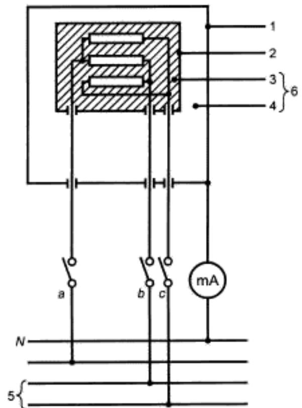
1 — доступная часть; 2 — недоступная металлическая часть; 3 — основная изоляция; 4 — дополнительная изоляция; 5 — трехфазное питание; 6 — двойная изоляция
