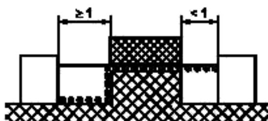
Условие — Рассматриваемый путь включает в себя несклеенное соединение, с одной стороны которого имеется паз шириной менее 1 мм, с другой — 1 мм и более.
