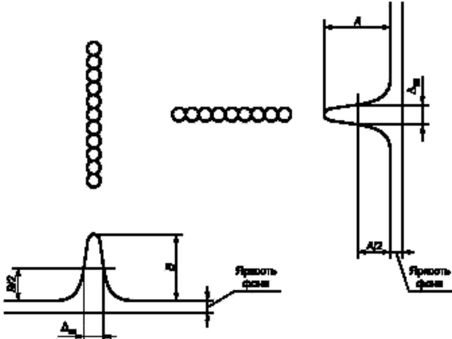
$A$  — разность максимальной яркости горизонтального штриха и яркости фона;  $B$  — разность максимальной яркости вертикального штриха и яркости фона;  $\Delta_w$  — ширина штриха
