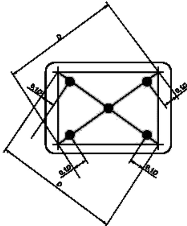
Рисунок 1 — Участки экрана, предусмотренные для измерения параметров изображения
