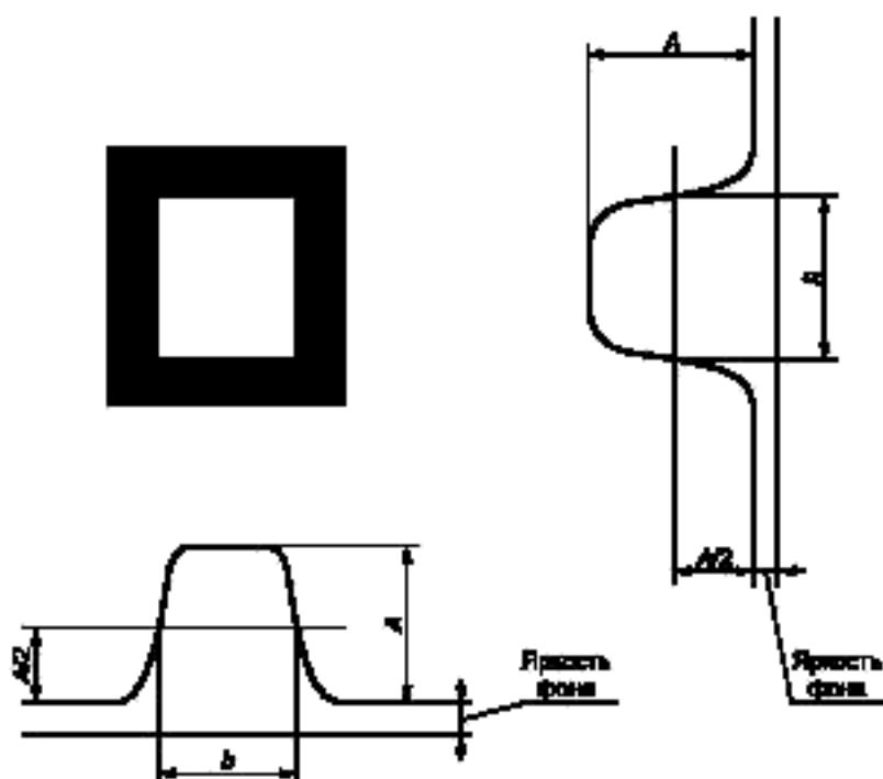
*a* — разность максимальной яркости знака и яркости фона; *b* — высота знака; *b* — ширина знака
