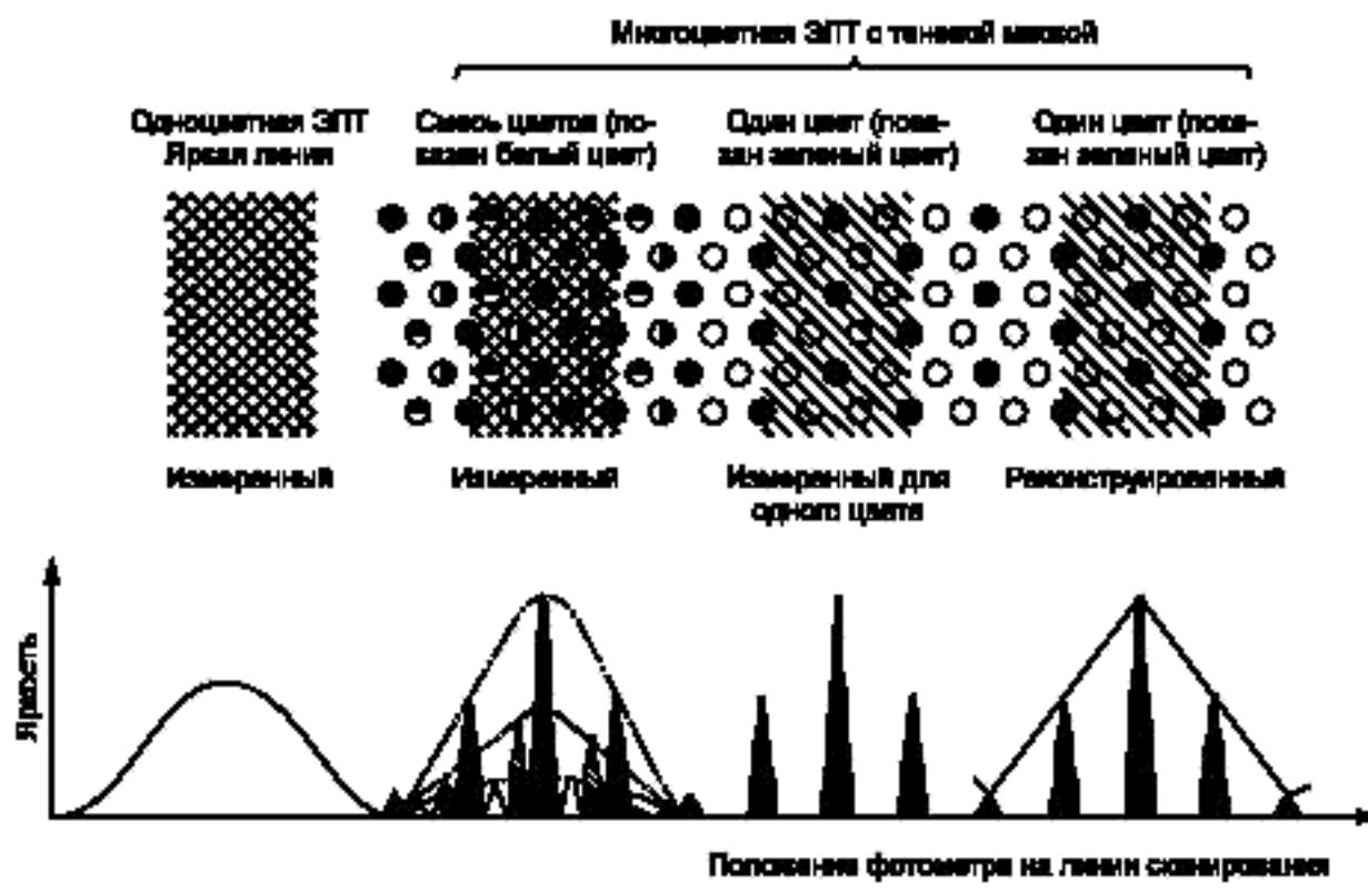
Рисунок Г.1 — Построение профиля яркости детали изображения
