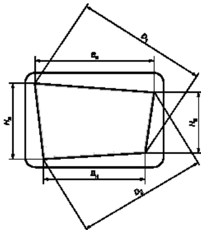
Рисунок 6 — Определение отклонения рабочего поля от прямоугольной формы
