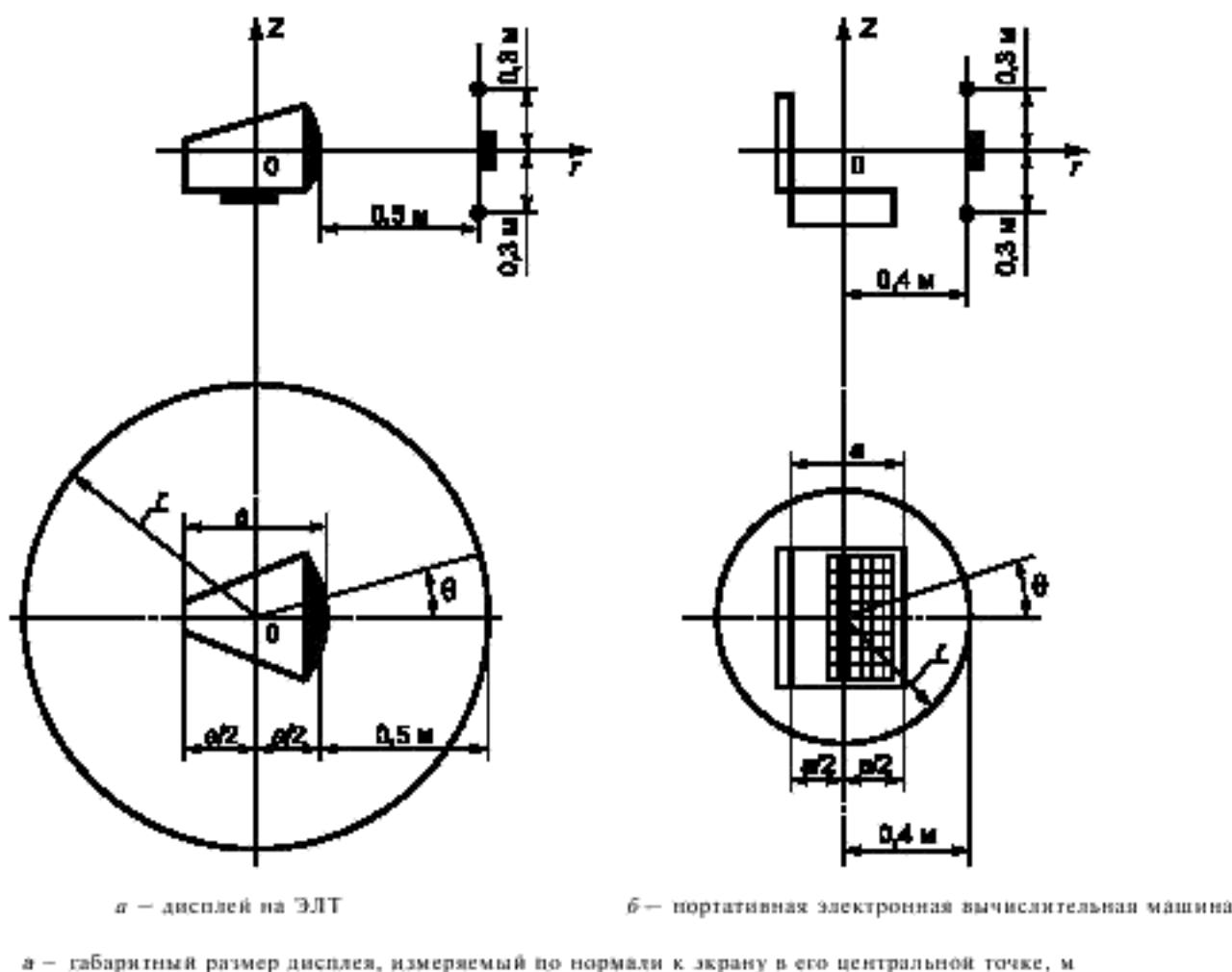
Рисунок 8 — Схема расположения дисплеев в цилиндрической системе координат
