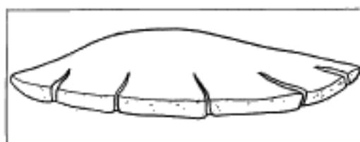
Лепешки, выдержавшие испытания на равномерность изменения объема
