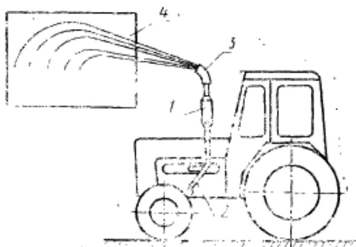
1 — искрогасящее устройство; 2 — устройство для сбора искр; 3 — колено трубы; 4 — фотографуемый участок
