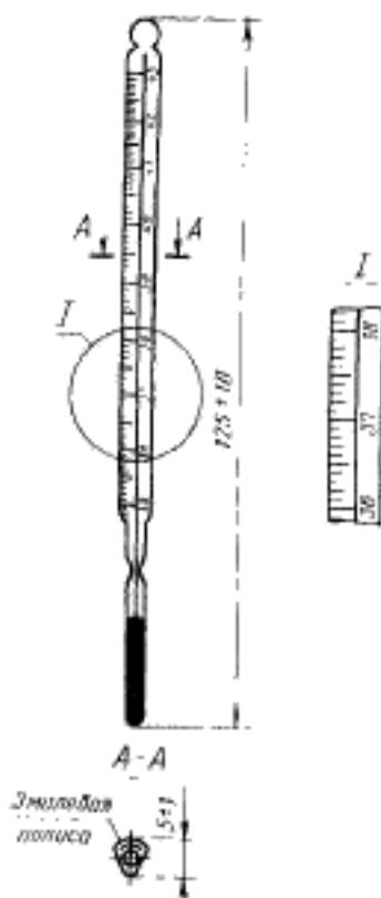
2.2. Термометр должен иметь специальное устройство, препятствующее спаданию ртутного столбика при охлаждении.
