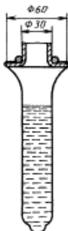
Рисунок 1 — Оборудование для удерживания презерватива
