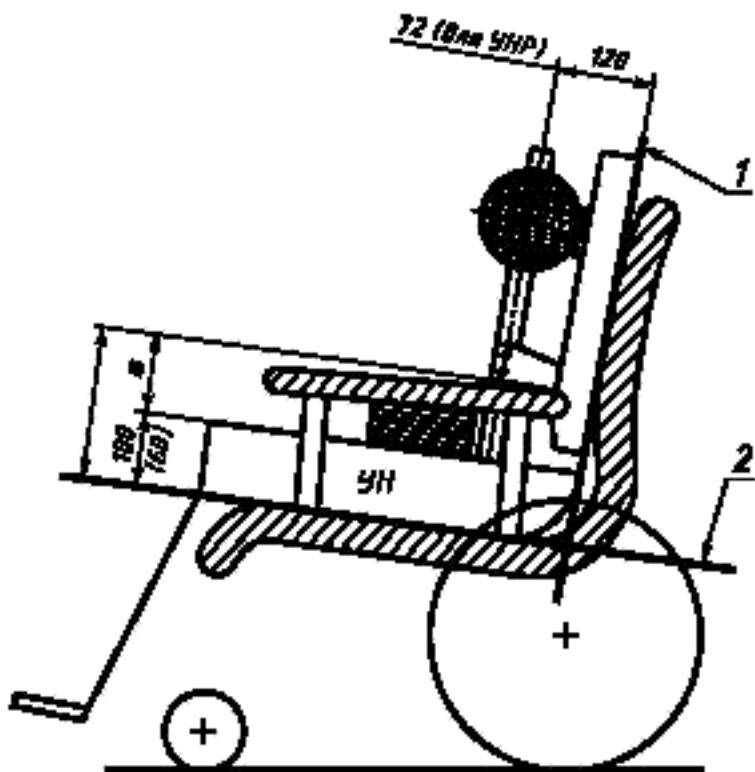
1 — базовая плоскость спинки; 2 — базовая плоскость сиденья
