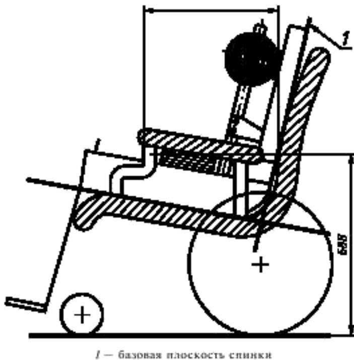
Рисунок 23 — Расположение узла подлокотника
