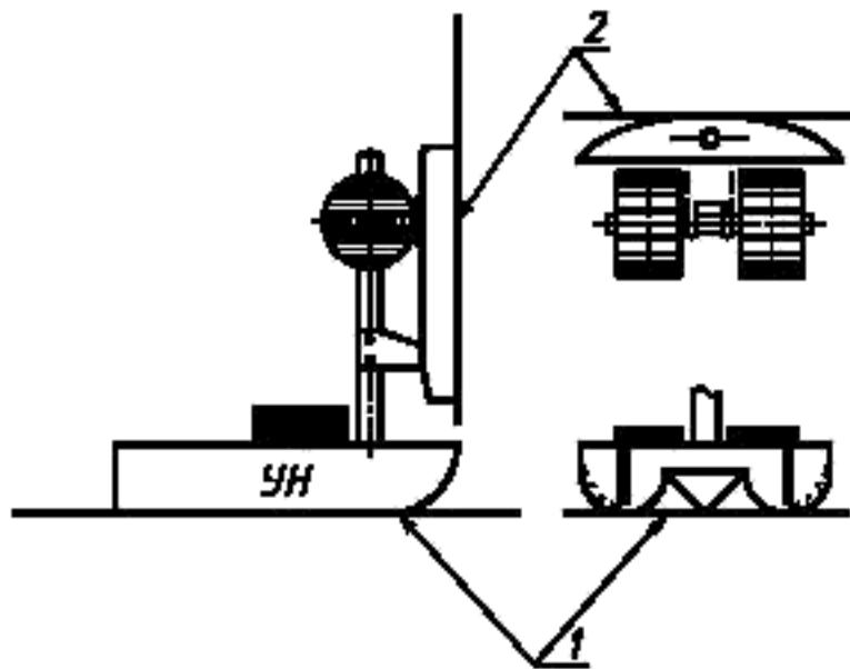
1 — базовая плоскость сиденья; 2 — базовая плоскость спинки
