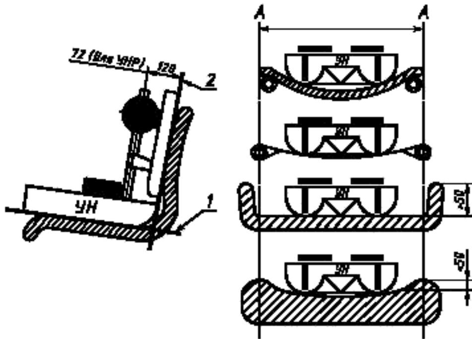
1 — базовая плоскость сиденья; 2 — базовая плоскость спинки
