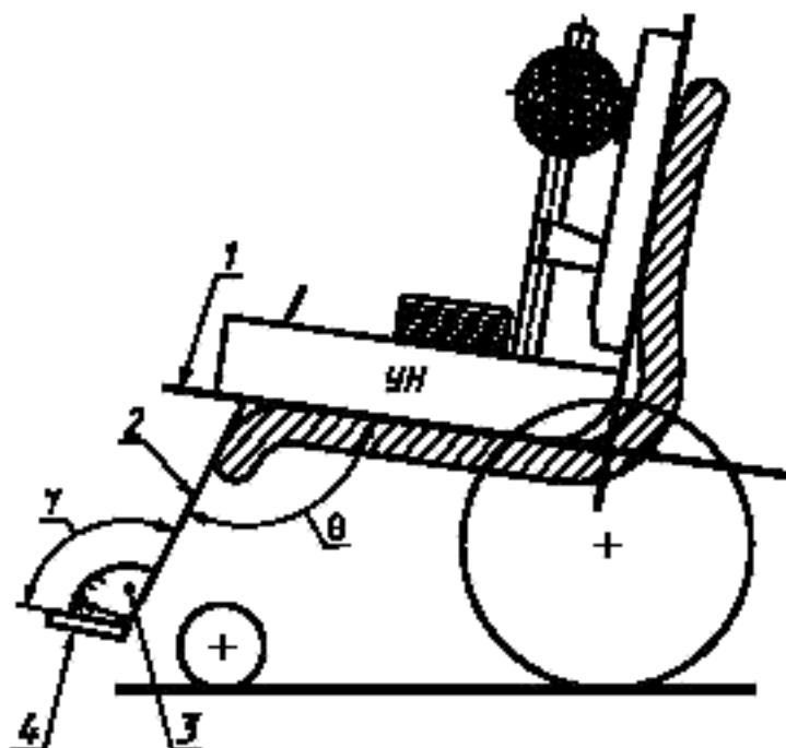
$\gamma$  — угол наклона опоры стопы;  $\theta$  — угол наклона подножки к поверхности сиденья; 1 — базовая плоскость сиденья; 2 — базовая плоскость подножки; 3 — угломер с индикатором; 4 — опора стопы
