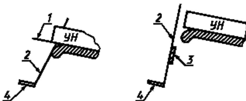
1 — базовая плоскость сиденья; 2 — базовая плоскость подножки;
