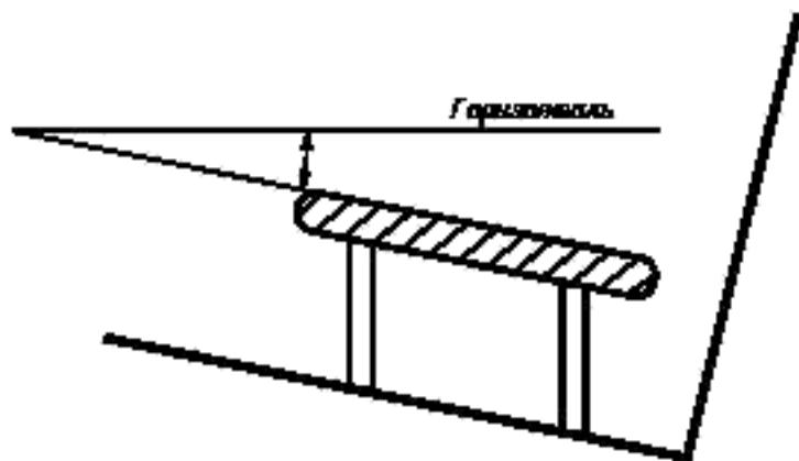
Рисунок 22 — Угол наклона подлокотника
