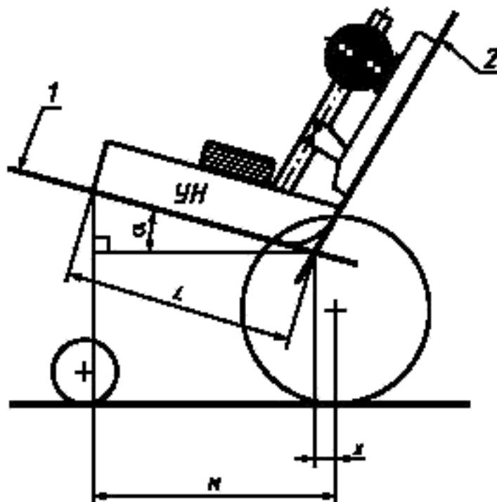
1 — базовая плоскость сиденья; 2 — базовая плоскость спинки
