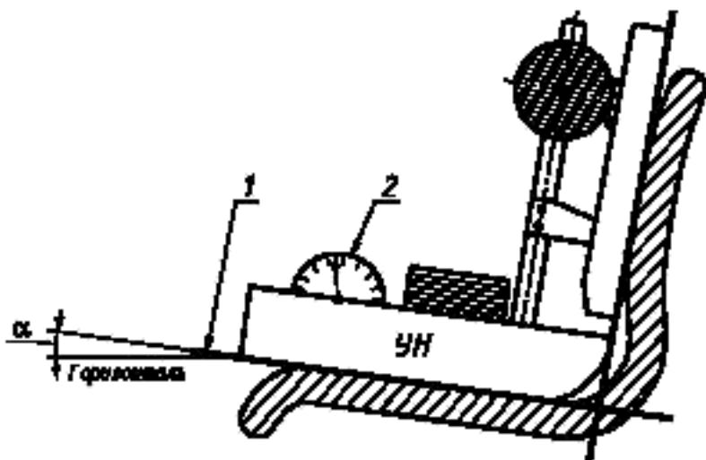
$\alpha$  — угол наклона сиденья; 1 — базовая плоскость сиденья;
