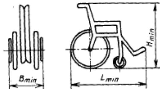
Рисунок 2 — Обозначение габаритных размеров кресел-колясок в сложенном виде
