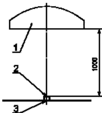
1 – ИЗДЕЛИЕ; 2 – ЦЕНТР СВЕТОВОГО ПОЛЯ (ЦСП); 3 – головка фотометра
