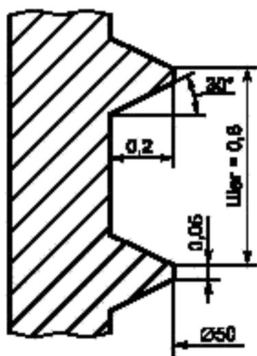
Рисунок 111 — Деталь внутренней поверхности трубыки (пример)
