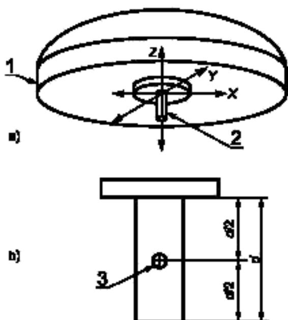
Деталь СТЕРИЛЬНОЙ РУЧКИ (где  $d$  – площадь захвата)
