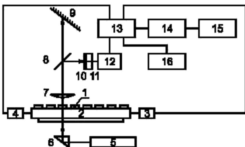
1 — капилляр; 2 — каретка; 3 — привод; 4 — блок терmostатирования; 5 — лазер; 6 — светоотделительная пластина; 7 — микрообъектив; 8 — светоотделительная пластина; 9 — экран; 10 — маска; 11 — фотодиод; 12 — усилитель; 13 — контроллер; 14 — компьютер; 15 — принтер; 16 — блок подготовки проб и рабочих образцов
