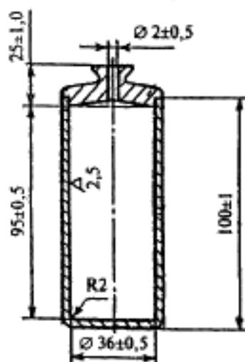
Рисунок 3 — Пикнометр
