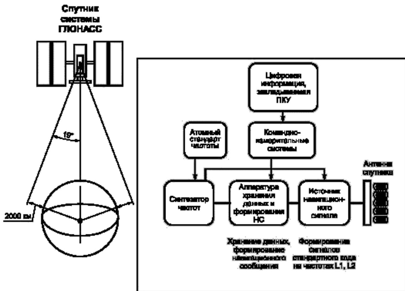
Рисунок А.1 — Процесс генерирования сигналов на спутнике
