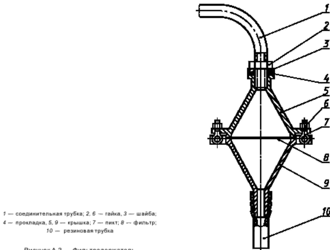
Рисунок А.2 — Фильтродержатель
