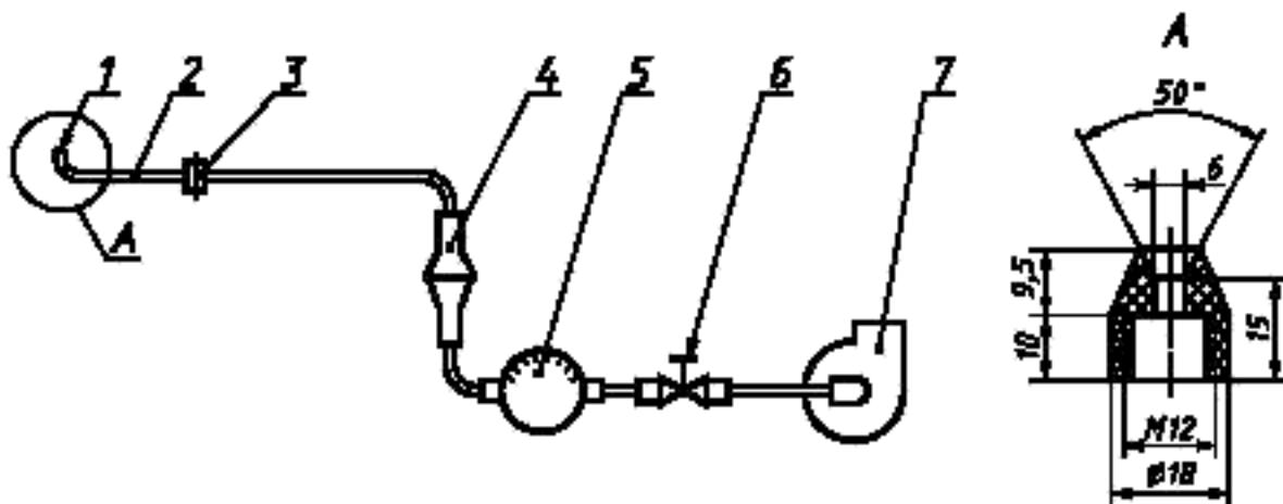
1 — насадка; 2 — воздухозаборная трубка; 3 — поворотное устройство; 4 — фильтродержатель; 5 — расходомер;
