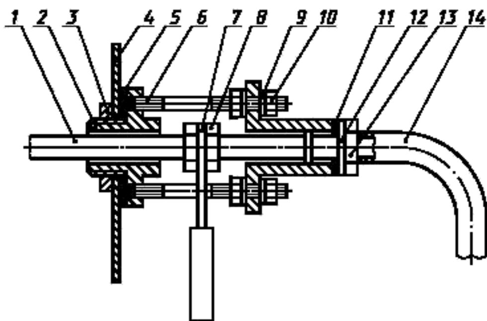
1 — воздухозаборная трубка; 2 — втулка; 3, 8, 10, 13 — гайка; 4 — стенка камеры; 5 — прокладка; 6 — шпилька; 7 — рукоятка;
