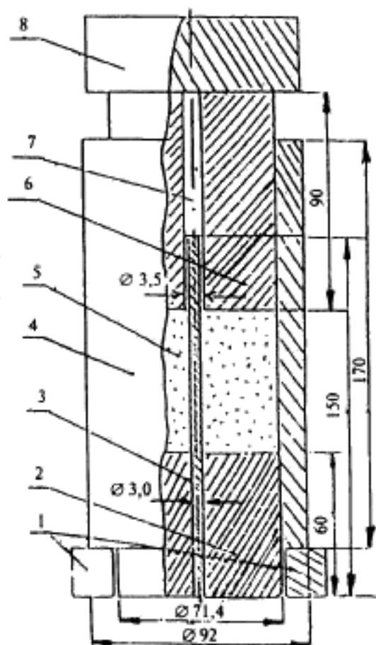
1 — подставка; 2 — нижний вкладыш формы; 3 — стальной стержень; 4 — цилиндрическая форма; 5 — образец; 6 — верхний вкладыш формы; 7 — сквозное отверстие; 8 — груз.
