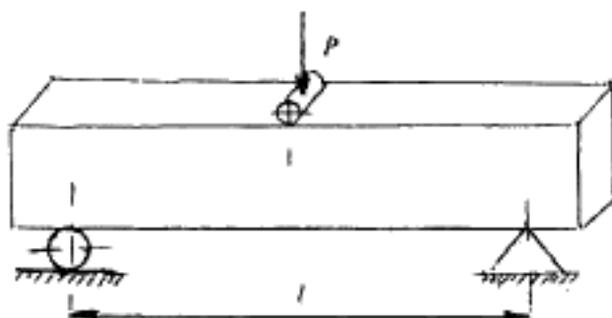
Рисунок 8 — Схема испытания образцов-призм на изгиб
