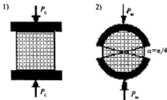
Рисунок 9 — Схема испытания образцов на сдвигустойчивость
