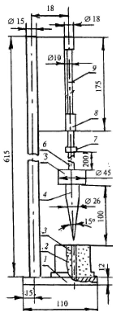
Рисунок 13 — Прибор для определения слеживаемости
