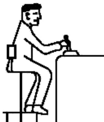
Рисунок 6 — Рекомендуемые направления движения руки оператора при использовании органа управления (в виде рычага) процессом подъема и опускания объекта
