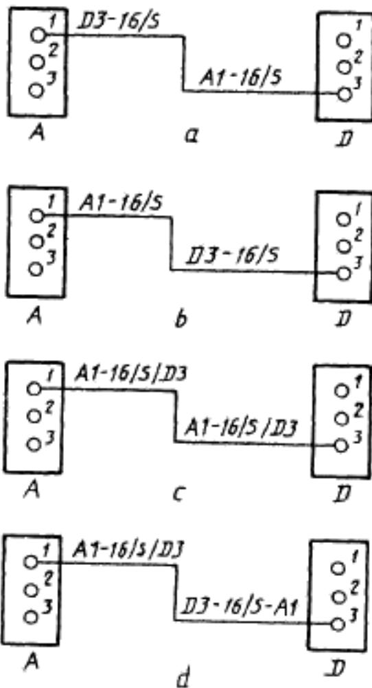
*a* — зависимая адресная маркировка; *b* — зависимая местная маркировка;
