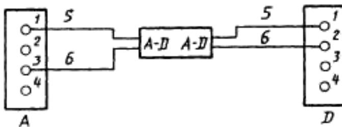
Черт. 8. Пример сложной маркировки: независимой для проводов;
