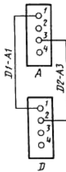
Пример С. Только промежуточная маркировка проводов
