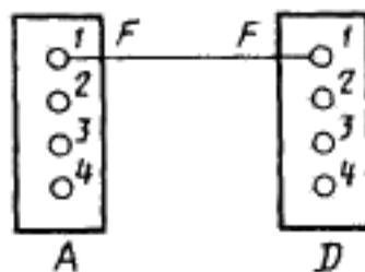
Черт. 6. Пример функциональной маркировки
