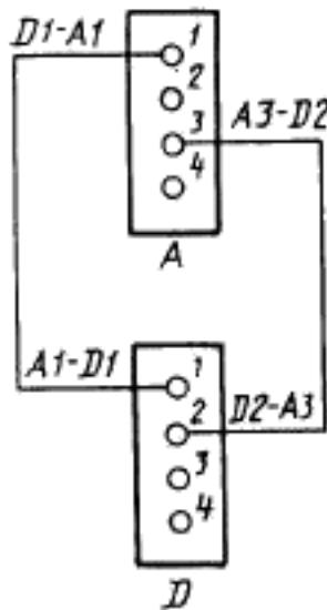
Пример В. Различная маркировка на концах проводов
