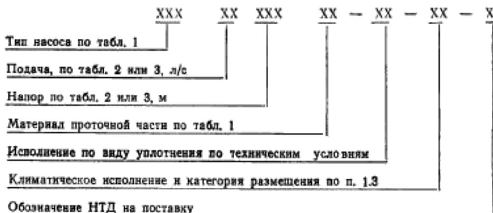
Пример условного обозначения насоса вихревого консольного с подачей 4 л/с, напором 28 м, с материалом проточной части из серого чугуна и бронзы с двойным торцовым уплотнением 2Г в климатическом исполнении У2
