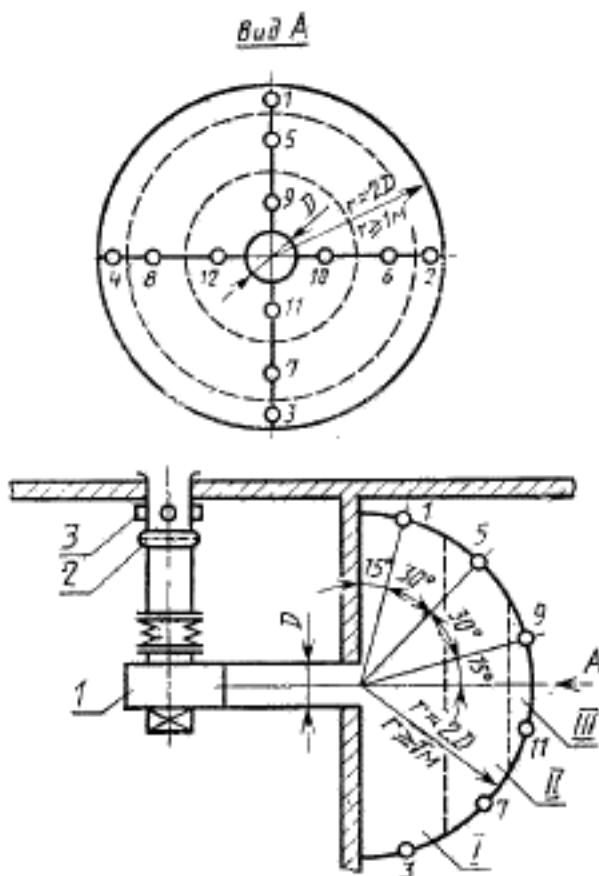
1 — испытываемый вентилятор; 2 — дросселирующее устройство; 3 — место измерения производительности; I, II, III — измерительные зоны; о — измерительная точка
