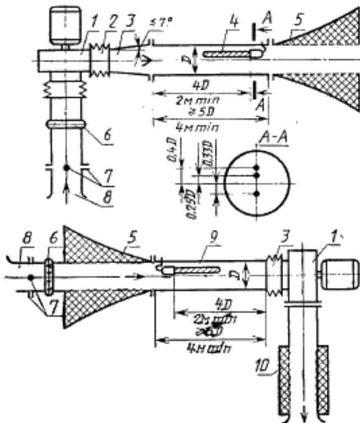
1 — испытываемый вентилятор; 2 — гибкая вставка; 3 — переходный участок; 4 — микрофон с ветрозащитной насадкой (см. черт. 8); 5 — концевое поглощающее устройство; 6 — дросселирующее устройство; 7 — места измерения производительности; 8 — измерительный коллектор; 9 — измерительный участок трубы; 10 — глушитель (рекомендуемый)
