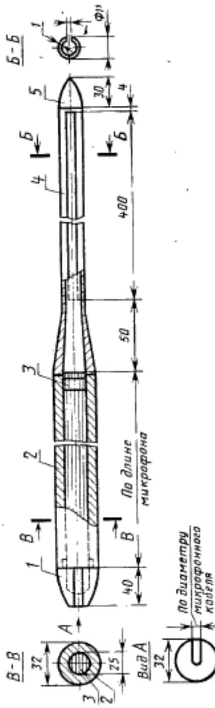
1 — концевой обтекатель; 2 — держатель микрофона; 3 — микрофон; 4 — трубка со щеткой, покрытой тканью; 5 — звуковой обтекатель
