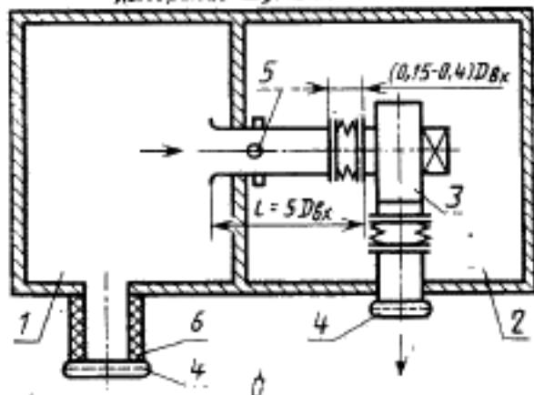
1 — помещение для измерения шума всасывания и нагнетания; 2 — помещение для измерения шума вокруг вентилятора; 3 — испытываемый вентилятор; 4 — дросселирующее устройство; 5 — место измерения производительности; 6 — шумоглушитель; 7 — измерительный коллектор
