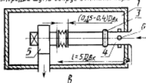
1 — помещение для измерения шума; 2 — шумоглушитель; 3 — дросселирующее устройство; 4 — измерительный патрубок; 5 — испытуемый вентилятор; 6 — место измерения производительности; 7 — измерительный коллектор
