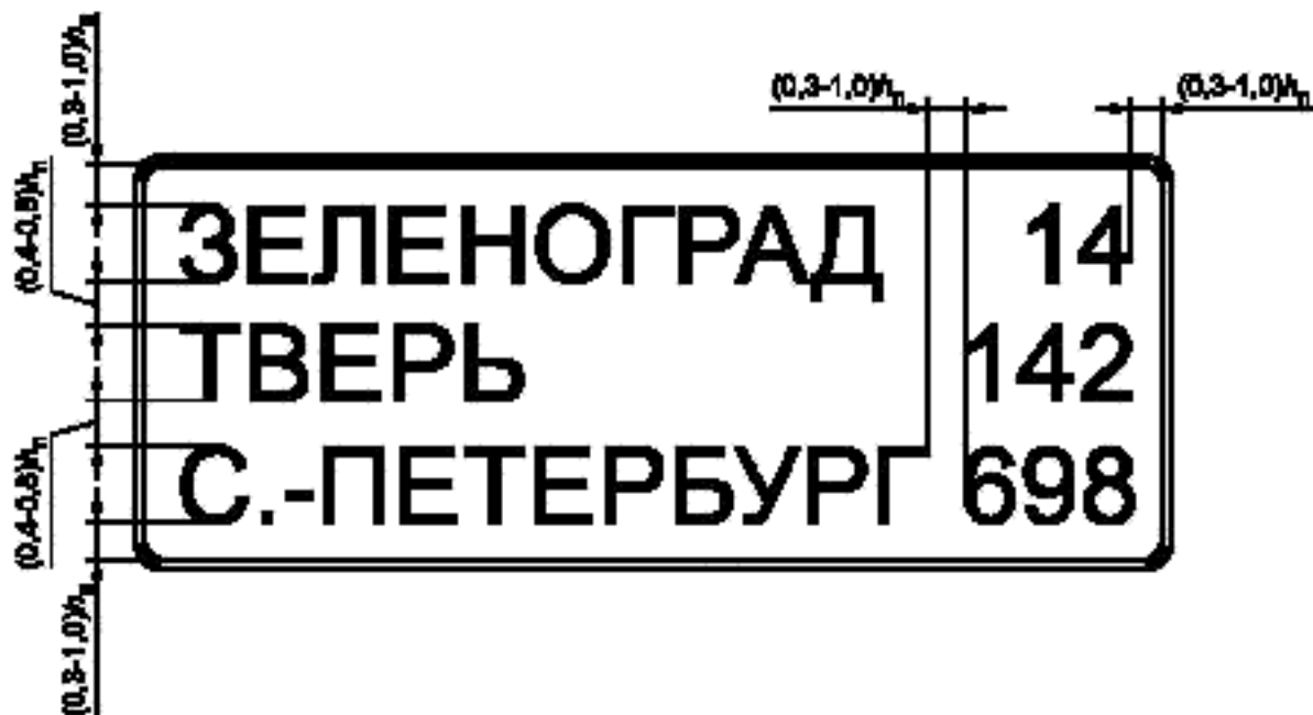
Рисунок Г.5 — Пример компоновки знака индивидуального проектирования 6.12
