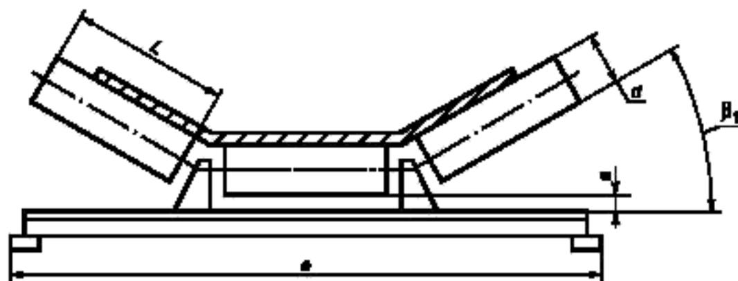
Рисунок 1 — Жесткая трехроликовая опора
