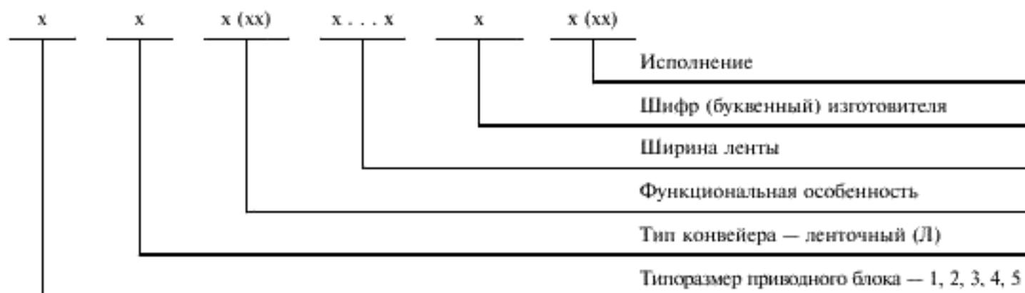
Обозначение типоразмеров приводного блока указано в таблице Б.1
