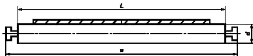
Рисунок 5 — Однороликовая опора
