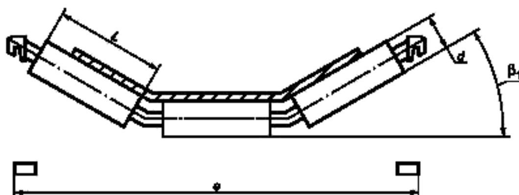
Рисунок 2 — Трехроликовая гирляндная опора
