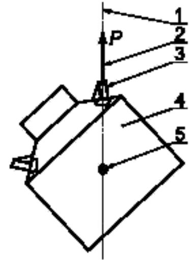
1 — линия, проходящая через центр тяжести и ручку; 2 — направление усилия, прилагаемого к ручке тары; 3 — испытываемая ручка тары при центральном расположении ручек; 4 — испытываемая тара; 5 — центр тяжести испытываемой тары
