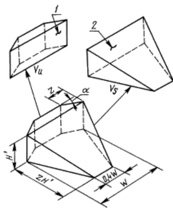
*I* — эффективный контур полусферического и сферического отвалов; *2* — прямой и поворотный отвалы
