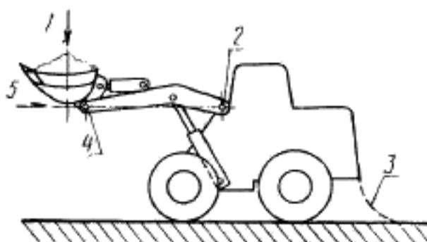
1—центр тяжести груза, находящийся на одной вертикали с геометрическим центром тяжести номинального объема ковша; 2—шарнир стрелы; 3—земная поверхность; 4—шарнир ковша; 5—шарнир стрелы и шарнир ковша, находящиеся на одинаковой высоте над уровнем опорной поверхности
