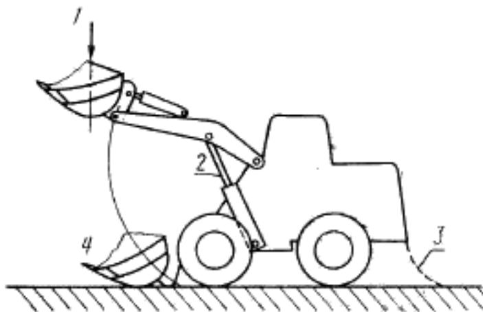
1—центр тяжести груза, находящийся на одной вертикали с геометрическим центром тяжести номинального объема ковша; 2—гидроцилиндр (цилиндр) перемещения стрелы; 3—не натянутые страховочные цепи для предотвращения опрокидывания машины; 4—груз, помещенный в ковш, полностью за-прокинутый на уровне опорной поверхности
