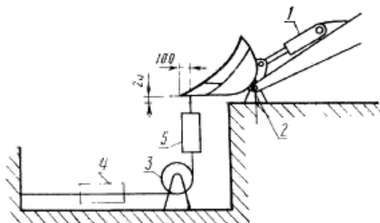
1—гидроцилиндр (цилиндры) поворота ковша; 2—опора под шарниром крепления ковша; 3—блок; 4—предпочтительное положение динамометра; 5—альтернативное положение динамометра
