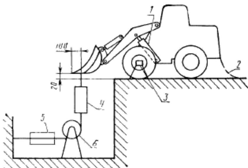
1—гидроцилиндр (цилиндры) перемещения стрелы; 2—ненапянутые цепи для предотвращения опрокидывания машины; 3—опора у осевой линии моста; 4—предпочтительное положение динамометра; 5—альтернативное положение динамометра; 6—блок
