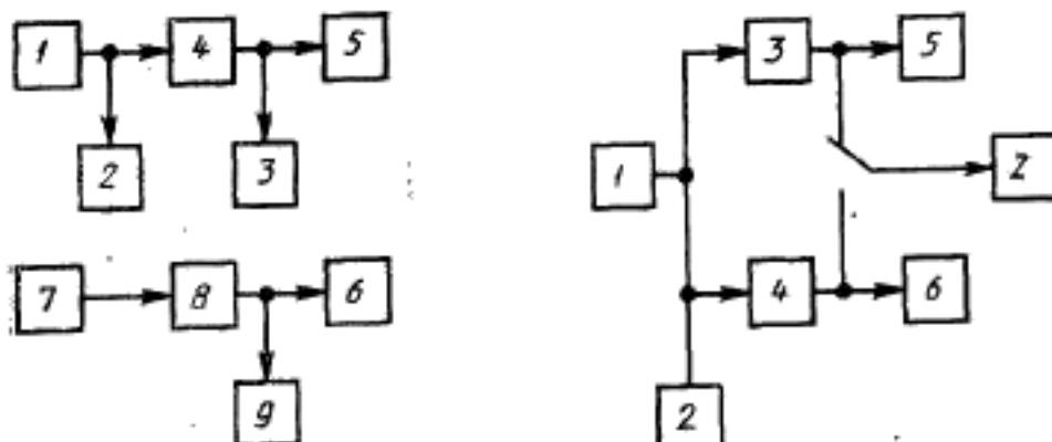
$1$  — низкочастотный генератор сигналов;  $2, 3$  — вольтметры;  $4$  — тракт, влияющий помеху;  $5, 6$  — номинальное сопротивление нагрузки — резистор;  $7$  — резистор — эквивалент сопротивления источника;  $8$  — испытуемый тракт;  $9$  — анализатор спектра или селективный вольтметр
