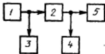
1 — низкочастотный генератор сигналов; 2 — измеряемый тракт или звено; 3, 4 — вольтметры; 5 —nominalное сопротивление нагрузки — резистор
