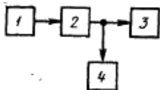
1 — резистор — эквивалент сопротивления источника; 2 — измеряемый тракт или звено; 3 — номинальное сопротивление нагрузки — резистор; 4 — психофотометр
