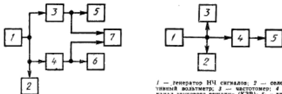
1 — генератор НЧ сигналов; 2 — вольтметр; 3 — частотомер; 4 — канал звукового вещания (КЗВ); 5 — анализатор спектра или селективный вольтметр; 6, 7 — номинальное сопротивление нагрузки — резистор; 7 — фазометр
