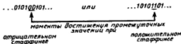
Шаг коррекции промежуточных значений временных сдвигов должен составлять 6/179 тактового интервала вторичного цифрового сигнала.
