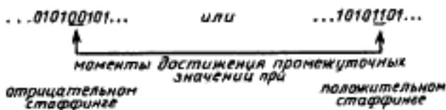
Шаг коррекции промежуточных значений временных сдвигов должен составлять 4/33 тактового интервала первичного цифрового сигнала.
