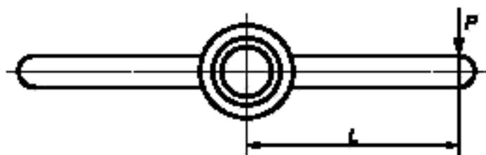
Рисунок 1 — Схема измерения момента вращения
