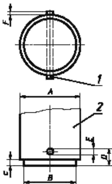
**П р и м е ч а н и е —** Цоколь предназначен только для испытания плюнжерных контактов при проверках сопротивления и электрической прочности изоляции, но не для проверки фиксации лампы
