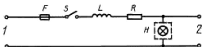
1 — источник питания; 2 — генератор импульса
