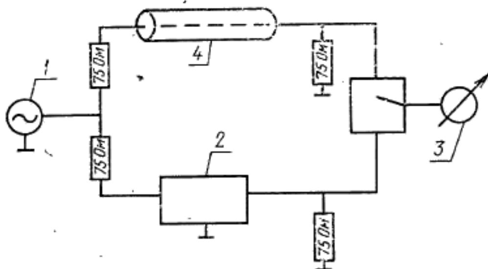
1—генератор; 2—магазин затухания; 3—индикатор; 4—измеряемая коаксиальная линия
