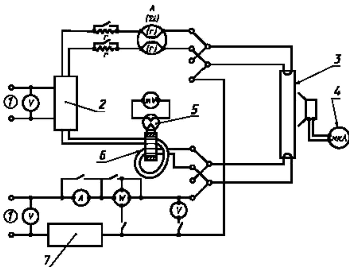
1 — источник питания; 2 — испытуемый ПРА; 3 — трансформатор тока; 4 — термопара; 5 — номинальная лампа;
