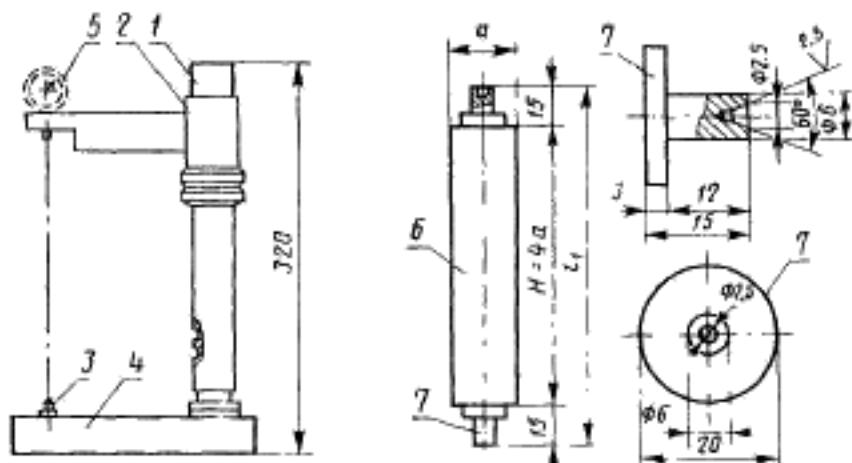
1—стойка; 2—кронштейн; 3—конусообразный выступ; 4—нижняя опора; 5—индикатор; 6—образец; 7—репер; а—размер сторон поперечного сечения образца; Н—высота образца; 1—база измерений
