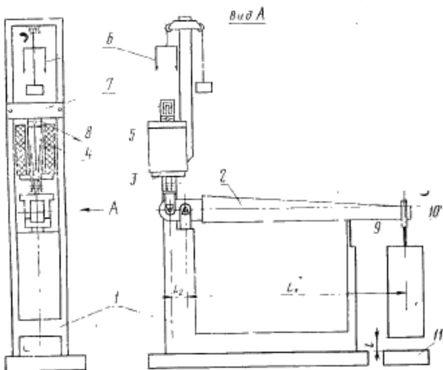
1—металлическая рама; 2—неравноплечий рычаг; 3—опорный столик; 4—обравец; 5—нагревательное устройство; 6—приспособление для подъема нагревательного устройства; 7—силовая балка; 8—металлические отводники; 9—страховочная стойка; 10—подвеска с грузами; 11—страховочная опора.
