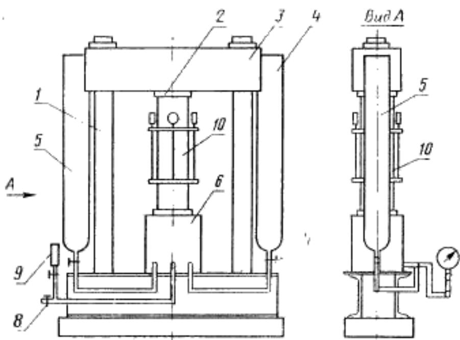
1—стойка; 2—верхняя опорная плита; 3—траверса; 4—баллон с инертными газом (с избыточным давлением по отношению к расчетному); 5—баллон с инертными газом при расчетном давлении; 6—гидравлический домкрат с шарнирной опорной плитой;
