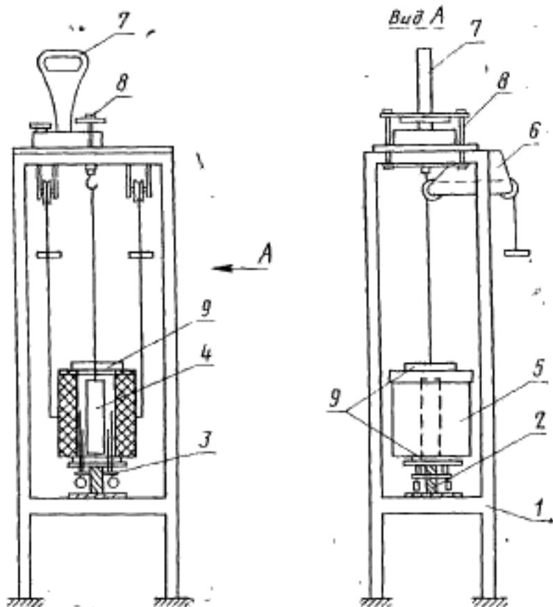
1—металлическая рама; 2—опорный столик; 3—выносные штанги; 4—образец; 5—нагревательное устройство; 6—система блоков для подъема нагревательного устройства; 7—весы; 8—приспособление для подъема и взвешивания образца; 9—теплоизоляция.
