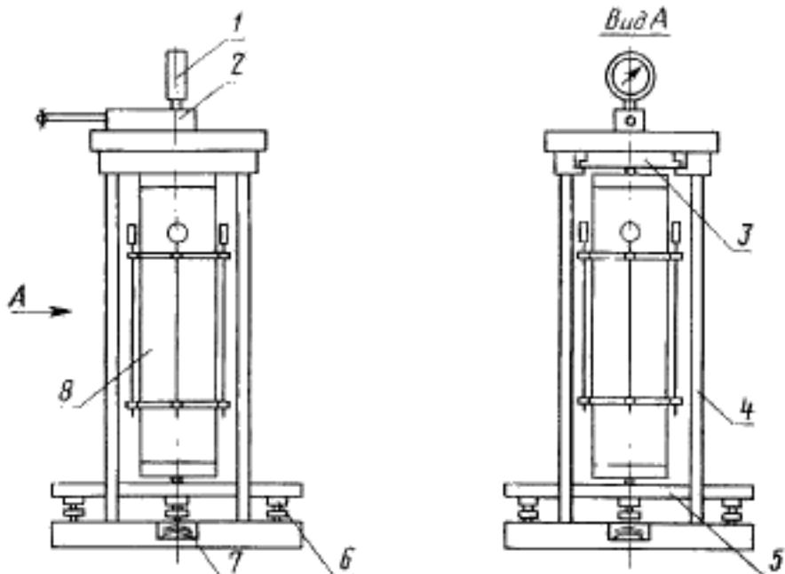
1—образцовый манометр; 2—гидравлический домкрат плунжерного типа с гибкой мембранией; 3—поршень домкрата; 4—стойки; 5—опорная плита; 6—регулировочные винты; 7—тарельчатые пружины; 8—образец
