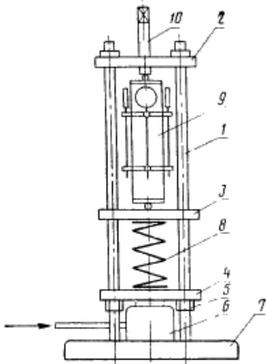
1—столбы; 2—верхняя траверса; 3—средняя траверса; 4—нижняя траверса; 5—гайки; 6—гидравлический домкрат; 7—простамент; 8—спиральная пружина; 9—бетонный образец; 10—установочный блок
