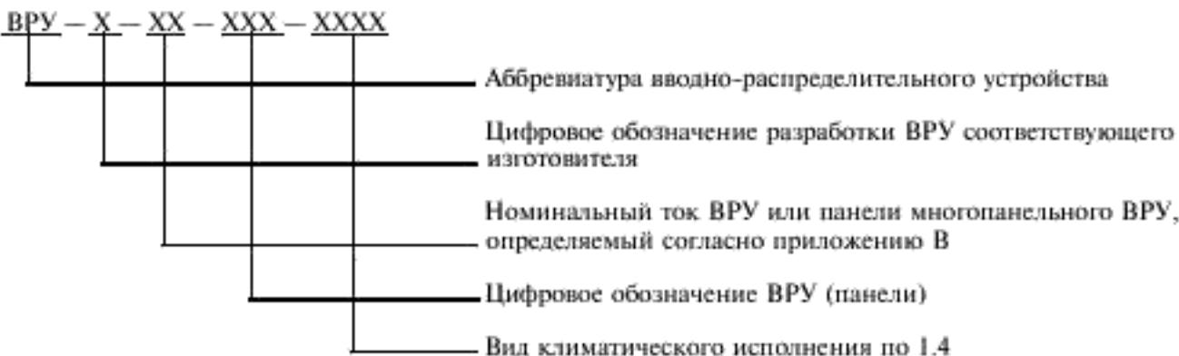
**Примеры обозначений типов панелей многопанельного ВРУ**
