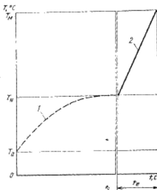
$T_0$  — температура окружающей среды;  $T_N$  — температура при номинальном режиме;  $T_M$  — максимальная температура; 1 — повышение температуры при номинальном режиме; 2 — повышение температуры в режиме короткого замыкания
