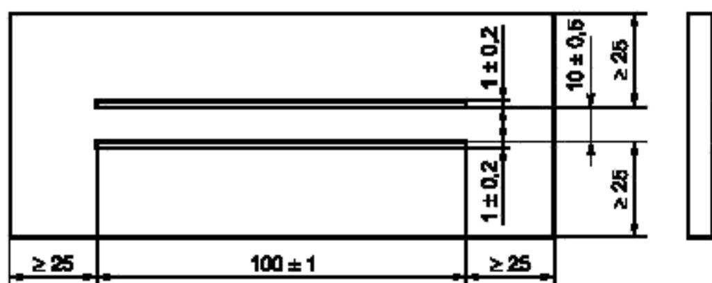
Рисунок 4 — Испытательный образец с электродами из проводящей краски
