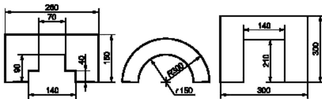
Рисунок 1 — Конструкция и размеры скоб для фиксации заготовок при ЭШС
