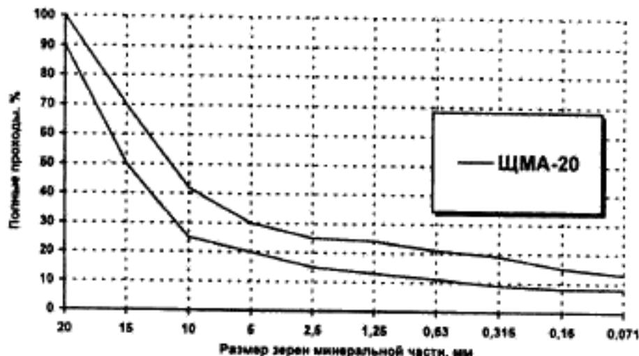
Рисунок Б.3 — Зерновой состав минеральной части ЩМА-20
