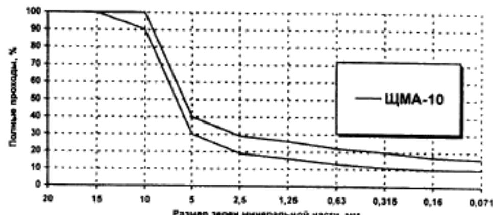
Рисунок Б.1 — Зерновой состав минеральной части ЩМА-10
