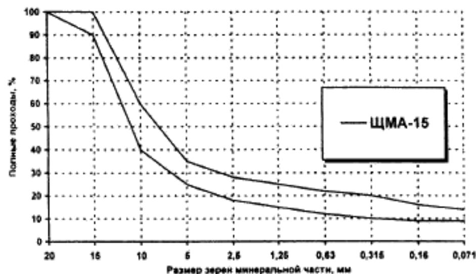
Рисунок Б.2 — Зерновой состав минеральной части ЩМА-15
